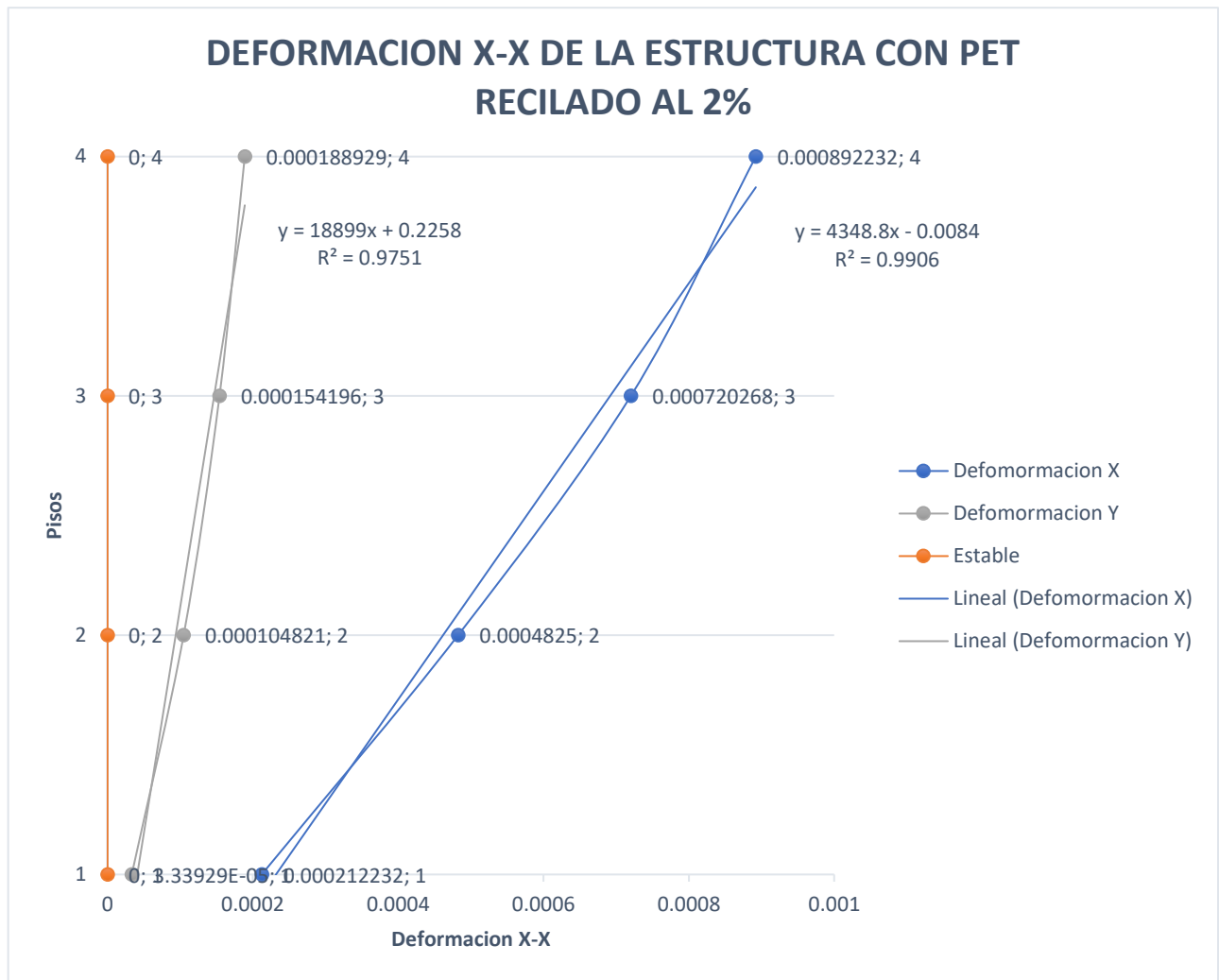
Figura 32. Deformaciones de la estructura con diseño al 2% de incorporación de las esferas de polietilenotereftalato reciclado.
