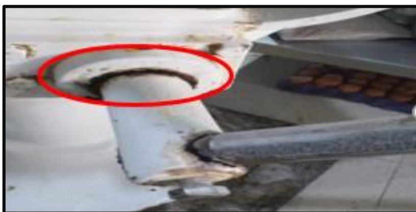
Engrasado en el giro de la palanca de presión
