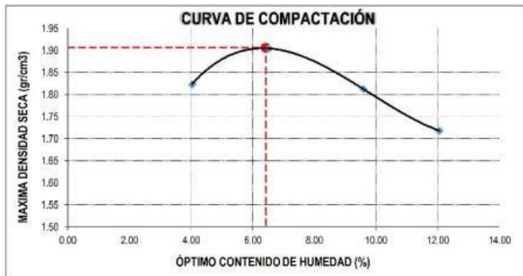
Figura 7. Se observa la curva de compactación del ensayo Proctor teniendo una máxima densidad seca de 1.906 g/cm 3 y un óptimo contenido de humedad 6.421%
