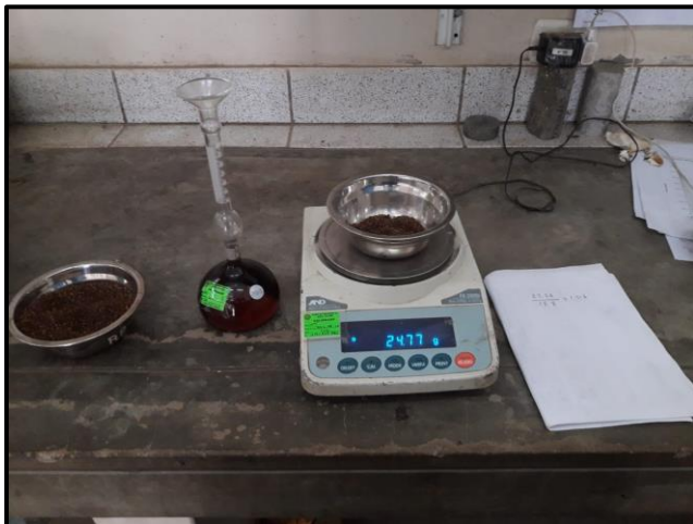
Figura 10. Peso de la muestra de orujo de aceituna para el Ensayo de Lechattellier
