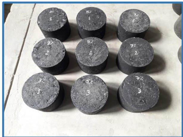
Figura 17. Especímenes con el incremento de orujo de aceituna (3%, 5%, 7%) ensayados
