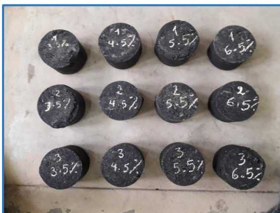
Figura 22. Especímenes con el incremento de (3%, 5%, 7%) de orujo de aceituna
