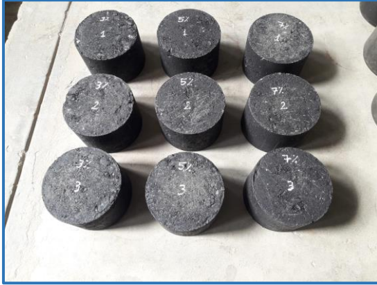
Figura 19. Especímenes para la determinación del flujo con el incremento al (3%, 5%, 7%) de orujo de aceituna
