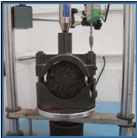
Figura 16. Determinación de estabilidad de especímenes con el incremento de (3%, 5%, 7%) de orujo de aceituna
