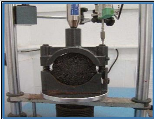
Ensayo de estabilidad y flujo de los especímenes
