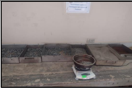
Dosificación de agregados grueso, fino y orujo de aceituna
