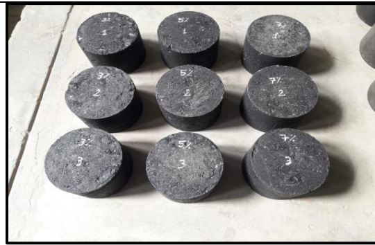
Especímenes con los porcentajes de 3%, 5% y 7% orujo de aceituna
