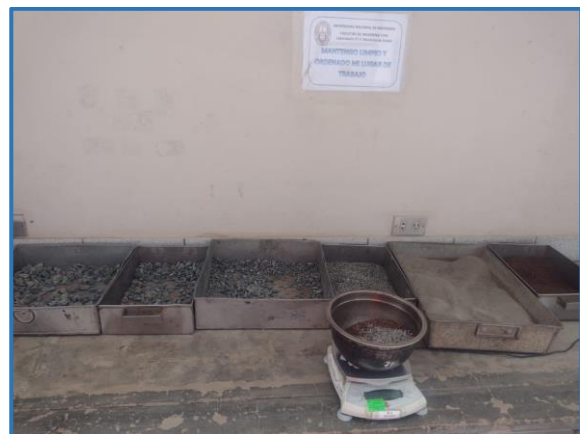
Figura 23. Muestra para la elaboración de especímenes (3%, 5%, 7%) de orujo de aceituna
