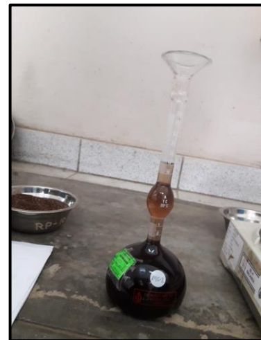
Figura 11. Ensayo de Lechattellier para obtener la gravedad específica de orujo de aceituna
