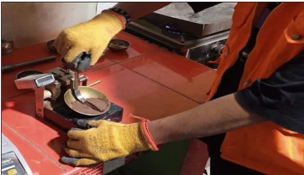
Figura 20. Ensayo de índice de plasticidad del suelo natural
