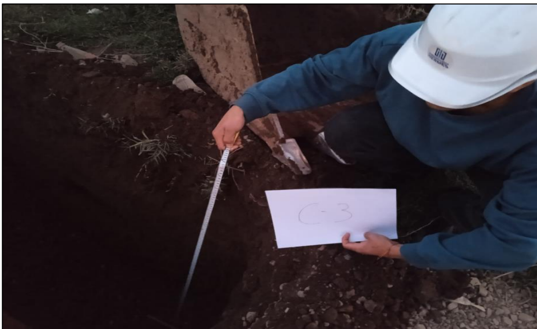
Figura 10. Extracción de material – calicata C3
