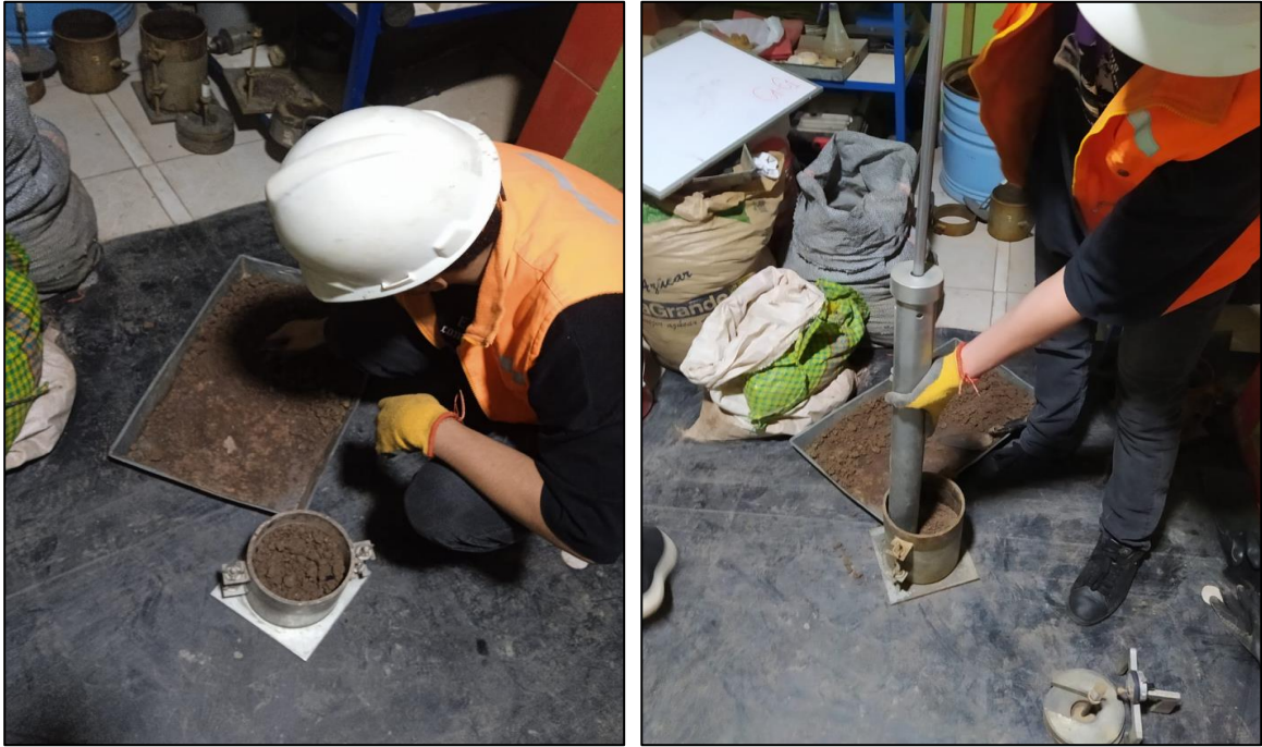
Figura 22. Ensayo de Proctor modificado del suelo natural
