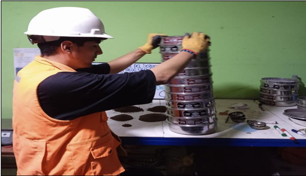
Figura 18. Ensayo de granulometría por tamizado del suelo natural
