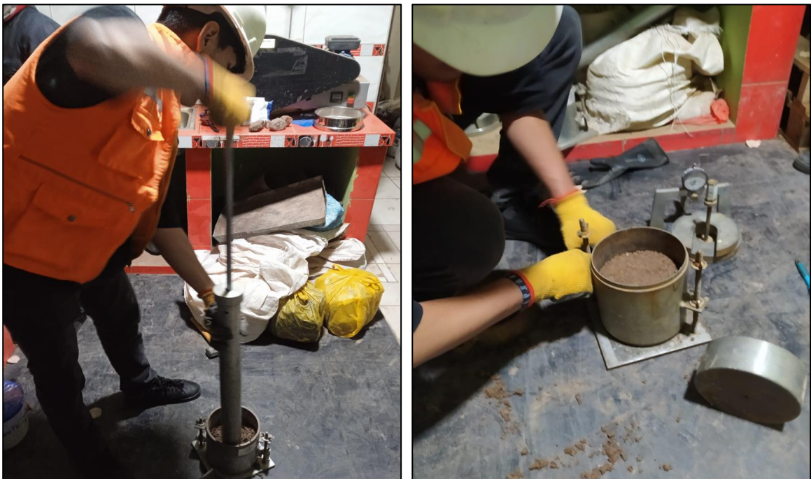
Figura 23. Ensayo de Proctor modificado del agregado de cantera
