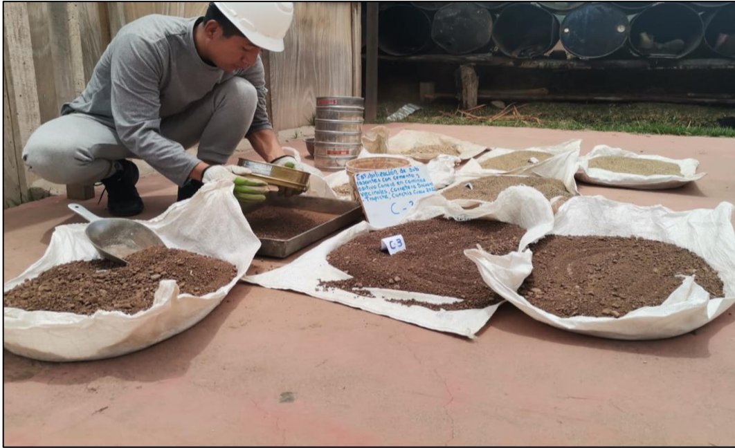
Figura 11. Cuarteo de material in situ
