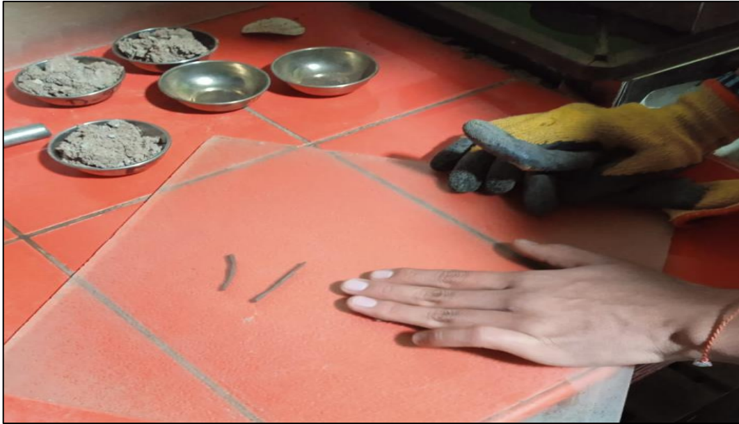
Figura 21. Ensayo de índice de plasticidad del agregado de cantera
