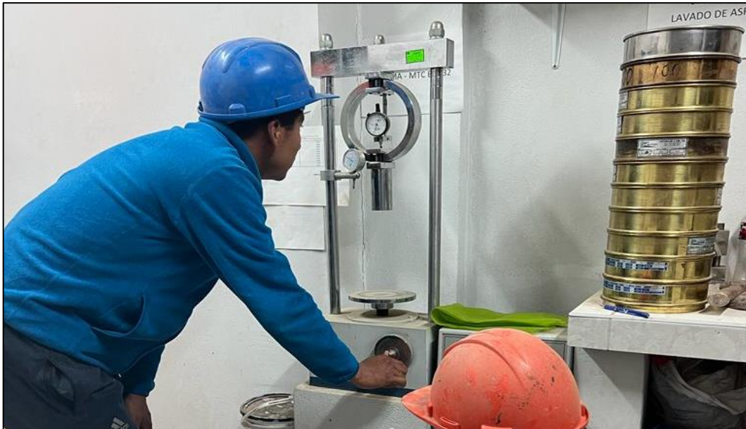
Figura 24. Ensayo de CBR del agregado de cantera
