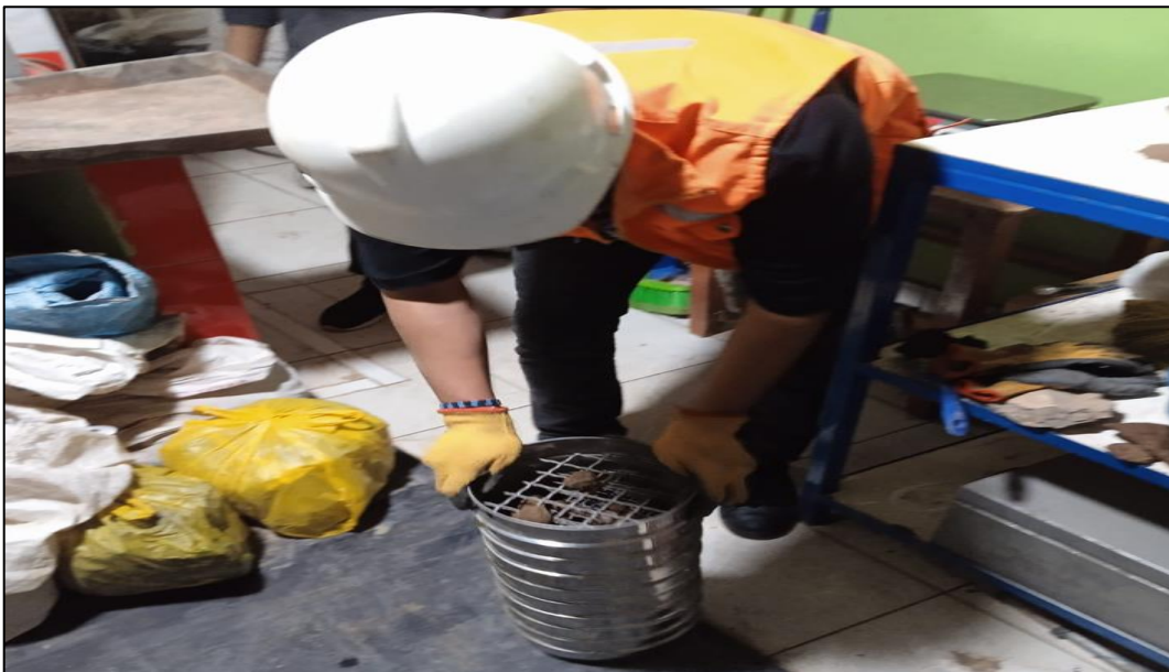
Figura 19. Ensayo de granulometría por tamizado del agregado de cantera
