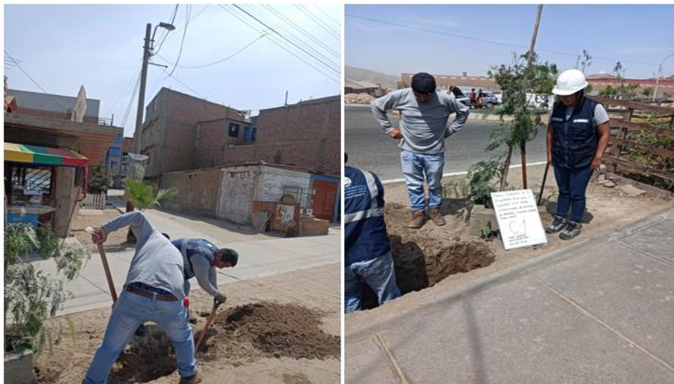
Figura 10. Extracción de muestras de la calicata 01
