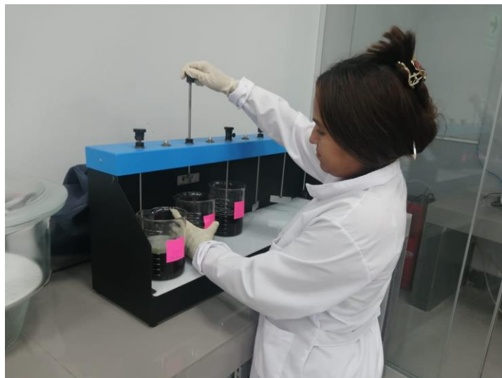
Se realizan las revoluciones en la prueba de jarras
