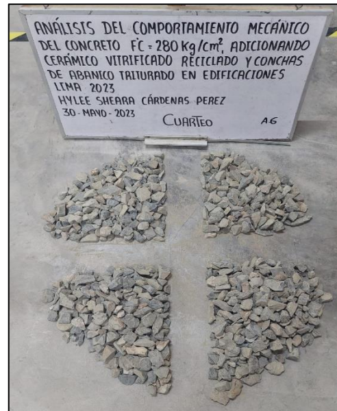
Cuarteo del agregado grueso
