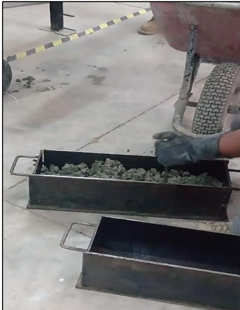
Llenado de las vigas de la muestra patrón
