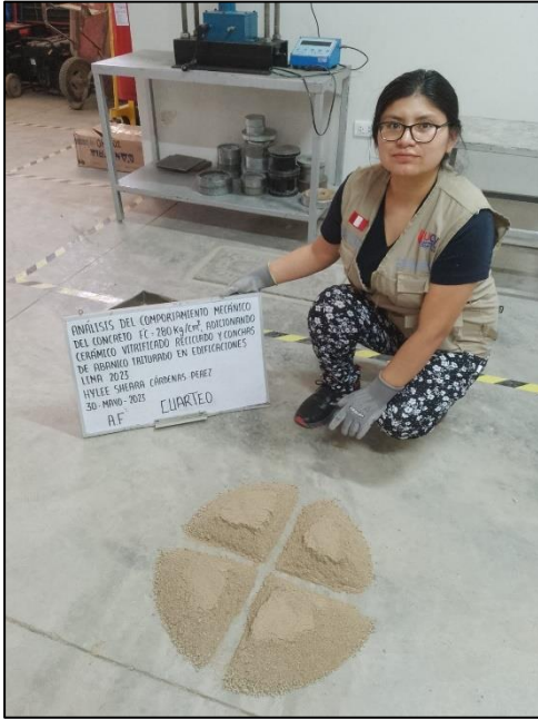
Cuarteo del agregado fino
