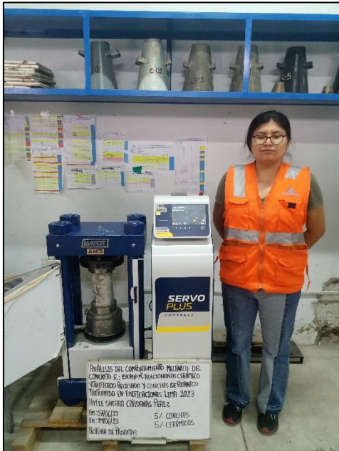
Rotura de probetas de la muestra 5%CVR+5%CAT
