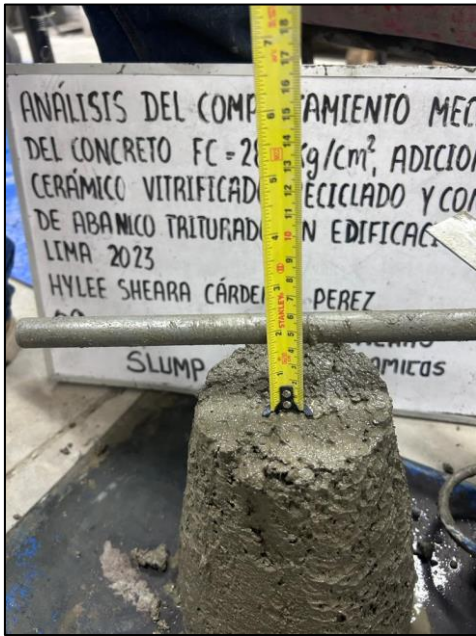
Slump 1 \frac{3}{4} " muestra con adición del 15%CVR+15%CAT
