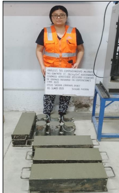
Probetas y vigas de la muestra patrón
