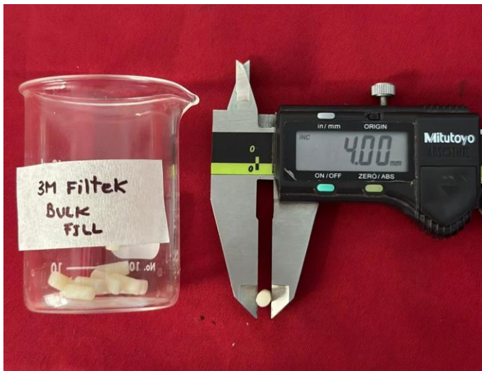
Figura 12: Medición de diámetro y altura de resina 3M Filtek Bulk Fill con calibrador Vernier.
