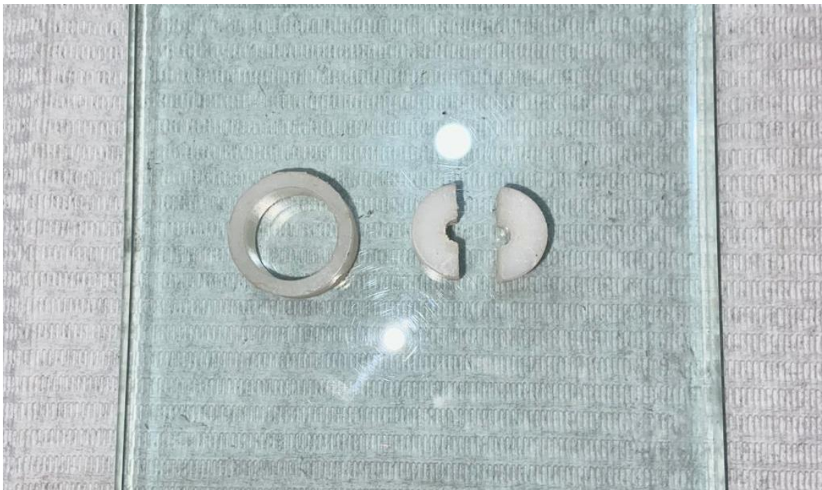
Figura 3: Molde con estructura de Nylon para la confección de las muestras.
