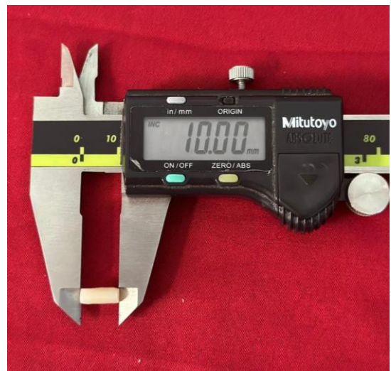
Figura 13: Medición de diámetro y altura de resina Tetric N-Ceram Bulk Fill con calibrador Vernier.
