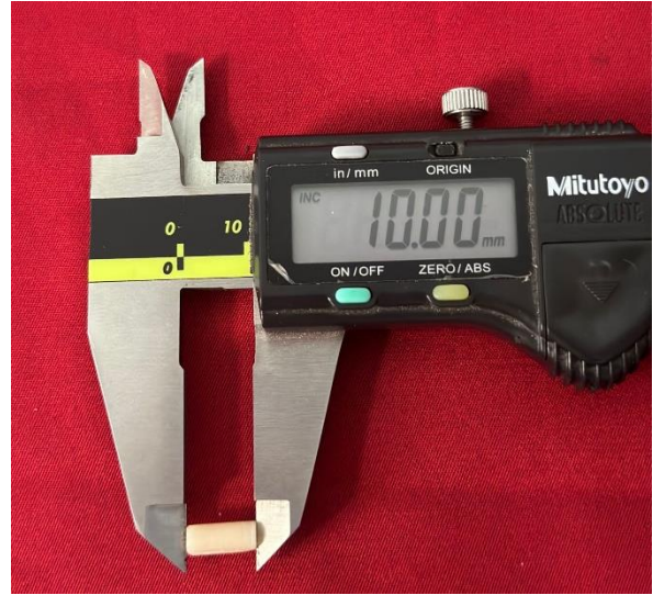
Figura 14: Medición de diámetro y altura de resina 3M Filtek Z350 XT con calibrador Vernier.
