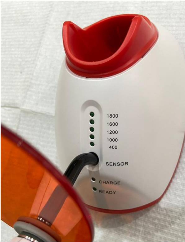
Figura 4: Calibración de lámpara Woodpecker modelo Led F.
