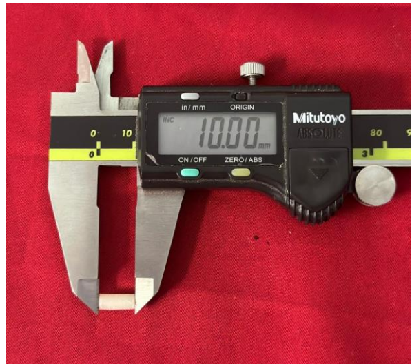
Figura 15: Medición de diámetro y altura de resina Vivadent Tetric N-Ceram con calibrador Vernier.
