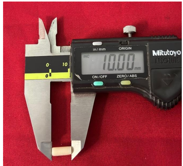
Figura 12: Medición de diámetro y altura de resina 3M Filtek Bulk Fill con calibrador Vernier.
