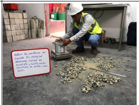
Imagen 12. Pesado del agregado grueso para el cálculo del peso unitario suelto. Fuente: Elaboración propia.
