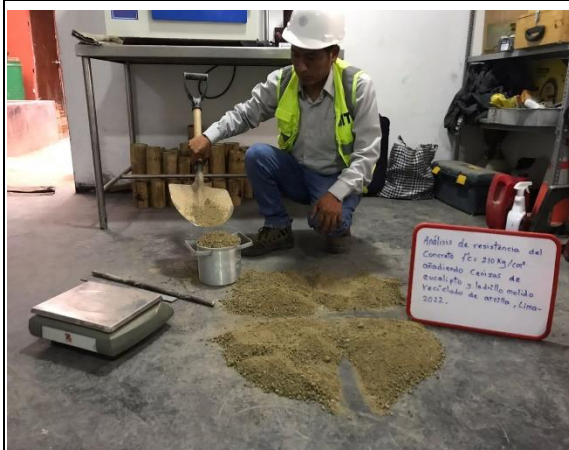
Imagen 19. Llenado de agregado fino para el cálculo del peso unitario suelto. Fuente: Elaboración propia.
