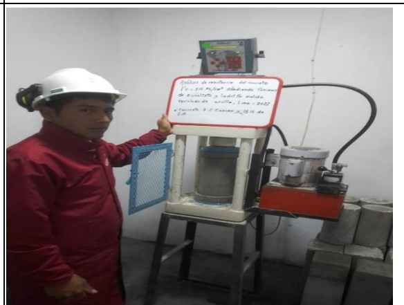
Imagen 24. Ensayo de resistencia a la flexión para un diseño con 7% C.E y 10% L.M.R.A. Fuente: Elaboración propia.
