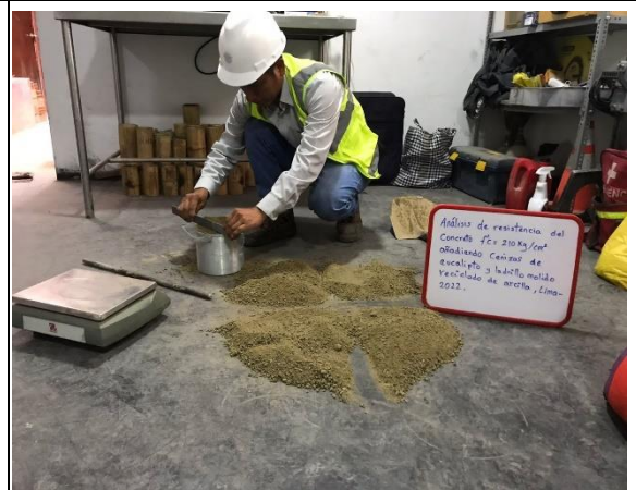
Imagen 20. Enrasado del agregado fino para el cálculo del peso unitario suelto. Fuente: Elaboración propia.
