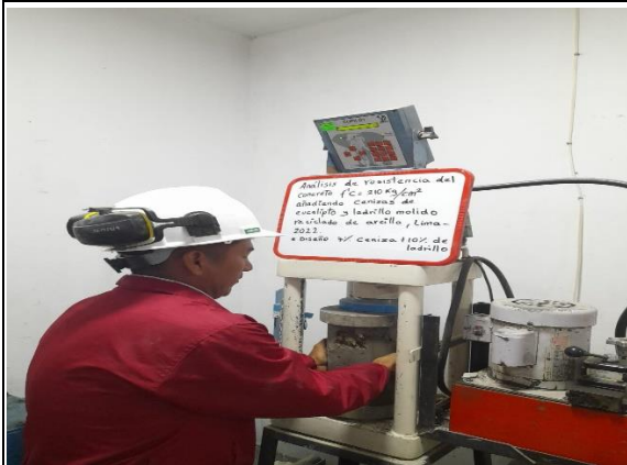
Imagen 33. Ensayo de resistencia a la compresión para el diseño de 7% C.E y 10% L.M.R.A. Fuente: Elaboración propia.
