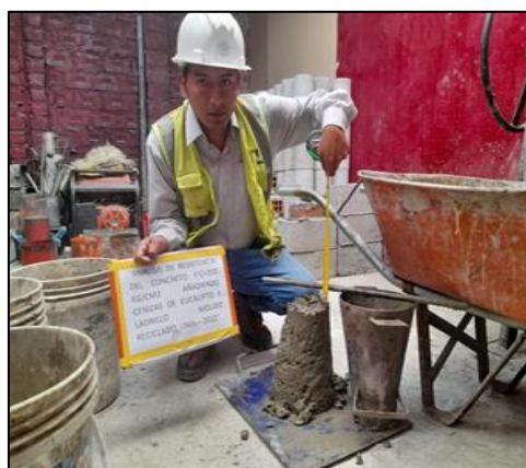
Figura 13. Prueba del ensayo de slump del concreto utilizando 7% de cenizas de eucalipto.
