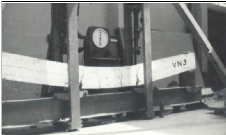
Figura 2. Ensayo para calcular la resistencia a la flexión en vigas con carga en el eje central del tramo
