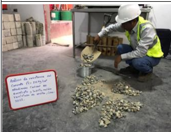
Imagen 11. Llenado del recipiente con agregado grueso para el cálculo de peso unitario suelto. Fuente: Elaboración propia.
