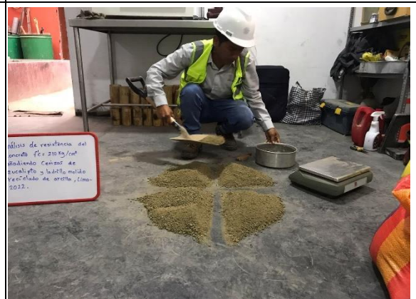
Imagen 16. Cuarteo del agregado fino. Fuente: Elaboración propia.
