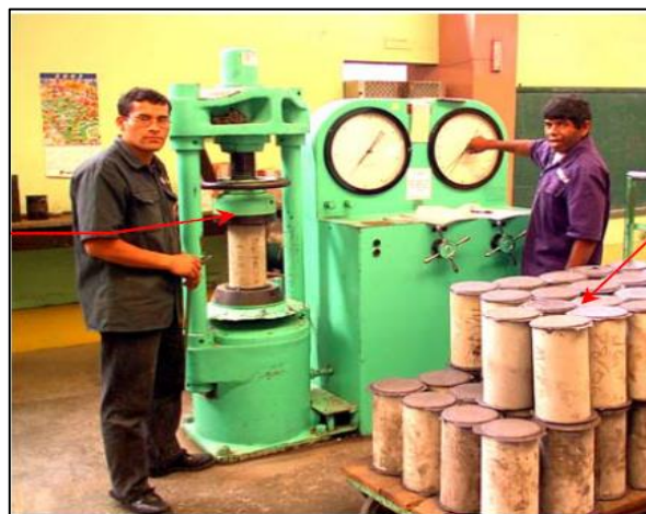
Figura 1. Ensayo a la compresión de especímenes cilíndricas.
