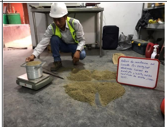
Imagen 24. Pesado del agregado fino para el cálculo del peso unitario compactado. Fuente: Elaboración propia.
