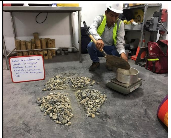
Imagen 8. Llenado y pesado del agregado grueso. Fuente: Elaboración propia.
