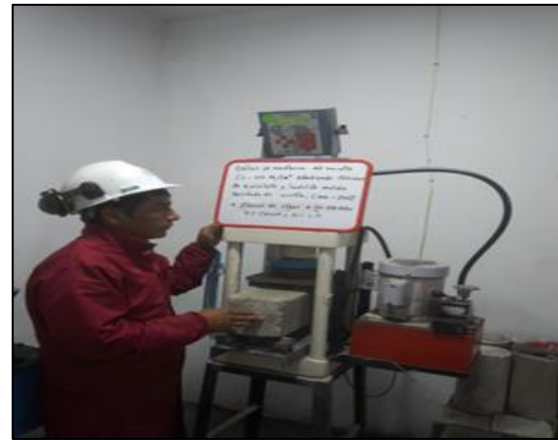
Figura 19. Ensayo de resistencia a la flexión, realizada al diseño de 7% de C.E y 10% de L.M.R.A.
