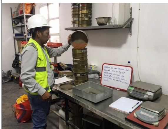
Imagen 25. Ensayo de granulometría del ladrillo molido reciclado. Fuente: Elaboración propia.
