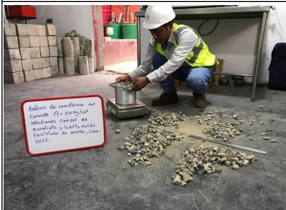
Imagen 15. Pesado del agregado grueso para el cálculo del peso unitario compactado. Fuente: Elaboración propia.
