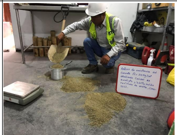
Imagen 22. Llenado del agregado fino para el cálculo del peso unitario compactado. Fuente: Elaboración propia.
