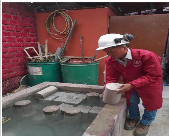
Imagen 31. Colocación de los especímenes de concreto en la cámara de curado. Fuente: Elaboración propia.
