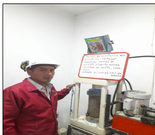
Figura 16. Ensayo de resistencia a la compresión, realizada a los 7 días para un diseño de 7% de ceniza de eucalipto y 15% de ladrillo molido reciclado de arcilla. Fuente: Elaboración propia.
