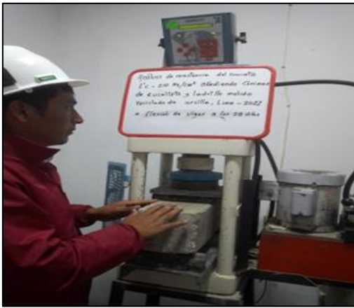
Figura 18. Ensayo de resistencia a la flexión, realizada a los 7 días para un diseño de 7% de C.E.
