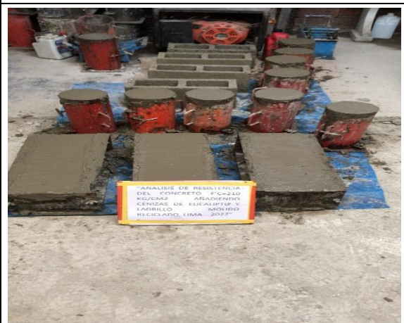
Imagen 30. Llenado de las probetas por el concreto diseñado. Fuente: Elaboración propia.
