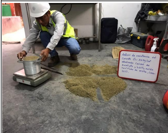
Imagen 21. Pesado del agregado fino para el cálculo del peso unitario suelto. Fuente: Elaboración propia.
