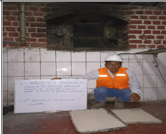
Imagen 4. Cenizas de eucalipto del segundo quemado en horno artesanal. Fuente: Elaboración propia.
