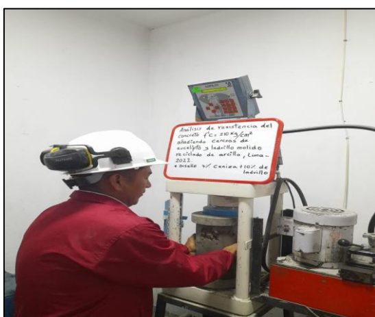
Figura 15. Ensayo de resistencia a la compresión, realizada a los 7 días para un diseño de 7% de ceniza de eucalipto y 10% de ladrillo molido reciclado de arcilla. Fuente: Elaboración propia.
