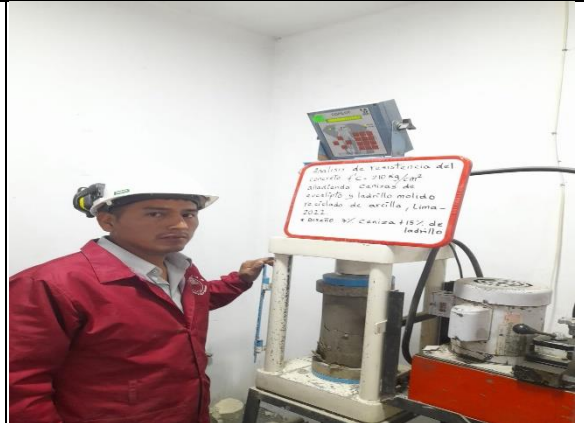
Imagen 34. Ensayo de resistencia a la compresión para el diseño de 7% C.E y 10% L.M.R.A.. Fuente: Elaboración propia.
