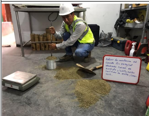
Imagen 23. Chuceado del agregado fino para el cálculo del peso unitario compactado. Fuente: Elaboración propia.
