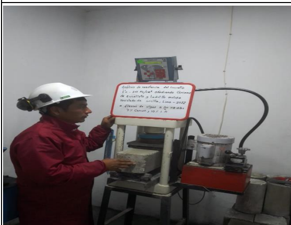
Imagen 23. Ensayo de resistencia a la flexión para un diseño con 7% C.E y 10% L.M.R.A. Fuente: Elaboración propia.
