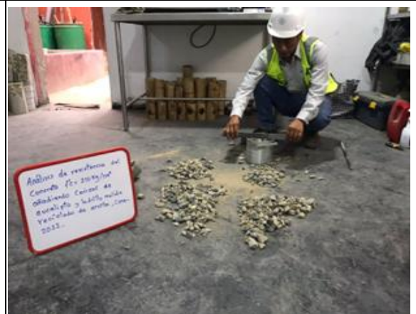
Imagen 14. Enrasado del agregado grueso para el cálculo del peso unitario compactado. Fuente: Elaboración propia.
