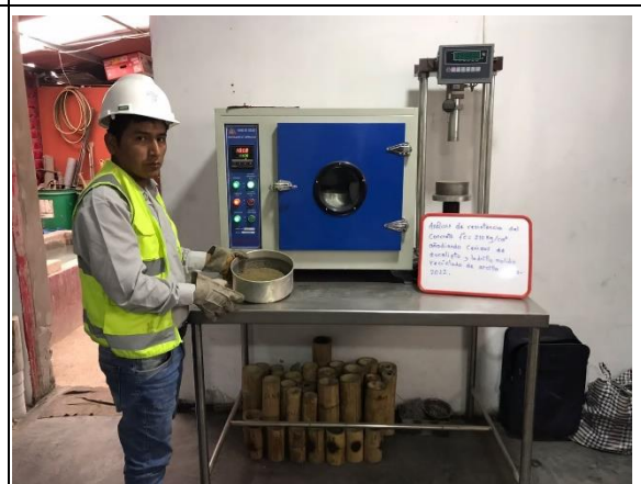
Imagen 18. Secado del agregado fino a 110°C por 24 horas. Fuente: Elaboración propia.
