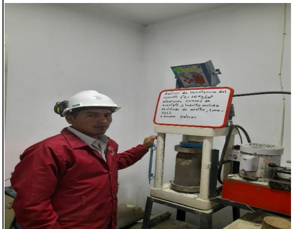
Imagen 32. Ensayo de compresión para el diseño patrón. Fuente: Elaboración propia.
