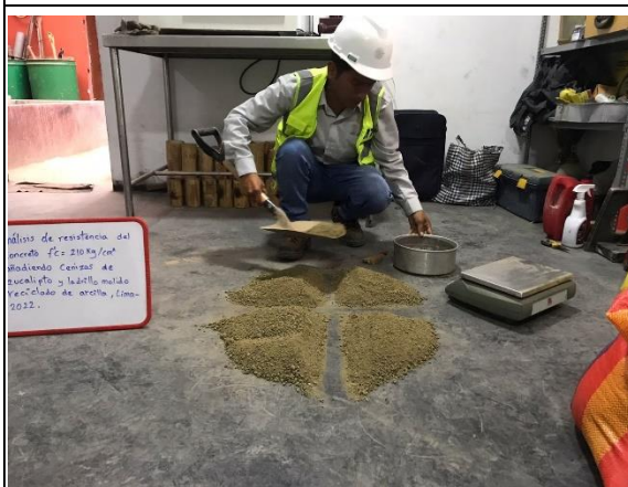
Imagen 17. Llenado y pesado del agregado fino. Fuente: Elaboración propia.
