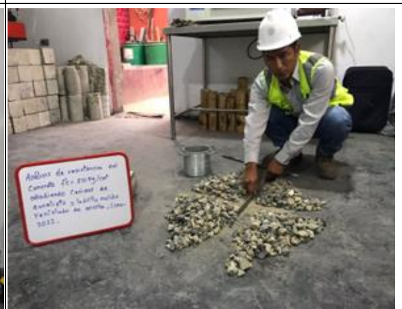
Imagen 10. Cuarteo del agregado grueso para el cálculo del peso unitario suelto. Fuente: Elaboración propia.
