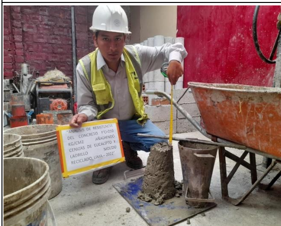
Imagen 29. Ensayo de Slump. Fuente: Elaboración propia.
