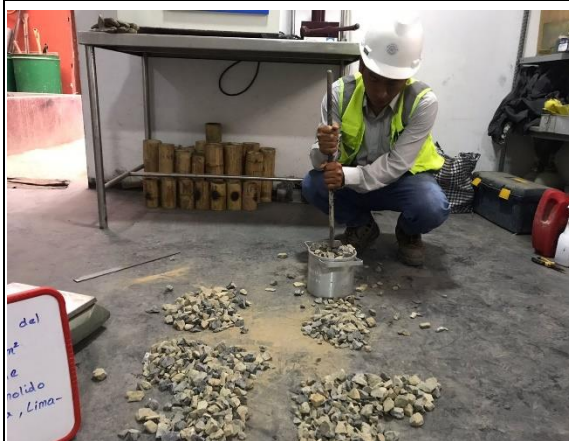
Imagen 13. Llenado y chuceado del agregado grueso para el cálculo del peso unitario compactado. Fuente: Elaboración propia.
