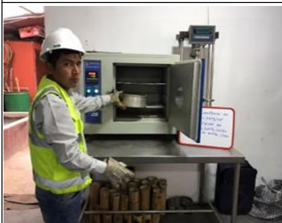
Imagen 9. Secado del agregado grueso a 110° C por 24 horas. Fuente: Elaboración propia.
