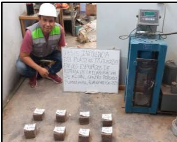
Ensayos de compresión en laboratorio (cubos de adobe)
