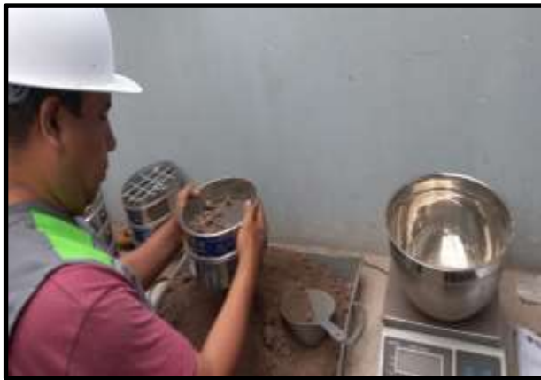
Realizando los análisis granulométricos del material extraído
