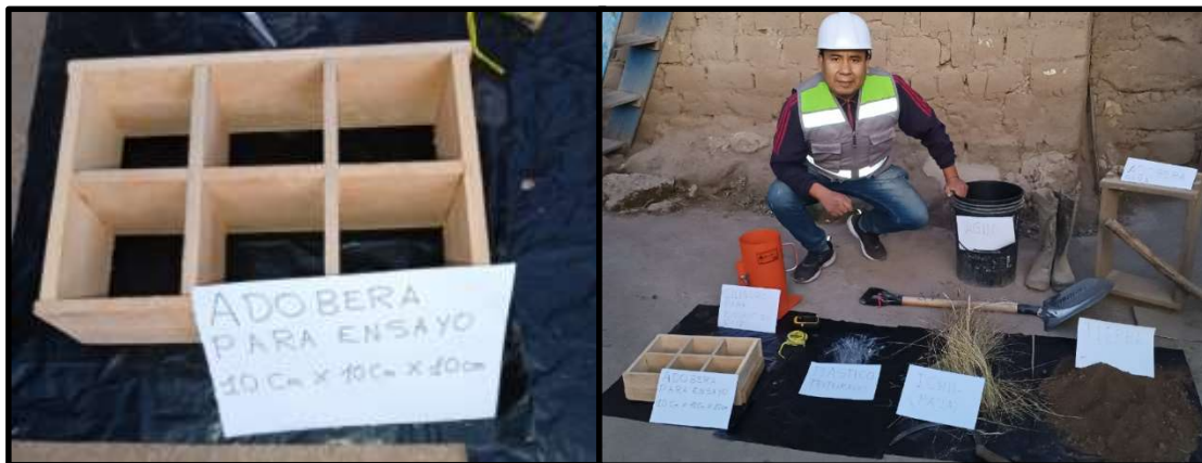
Figura 15. Moldes elaborados para el adobe (para laboratorio).
