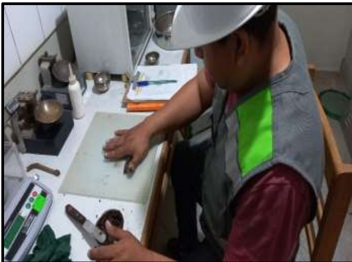
Figura 11. Cinta de barro elaborado con el material de la zona.
