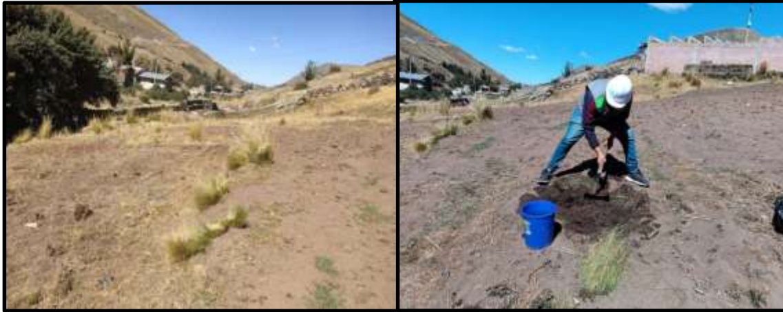
Figura 9. Recojo de materia prima para las muestras (adobe).
