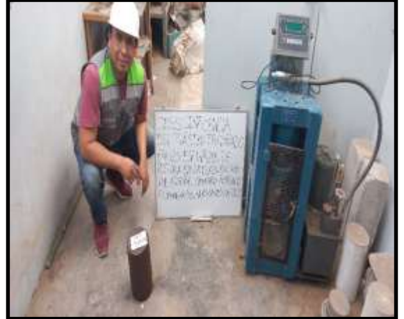
Especímenes (muestras) de adobe sin y con adición de plástico triturado (PET)
