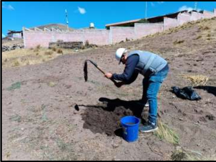
Figura 12. Extracción de material (suelo)
