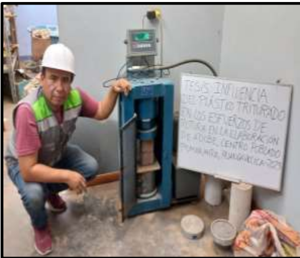
Ensayos de compresión en laboratorio (pilas de adobe)
