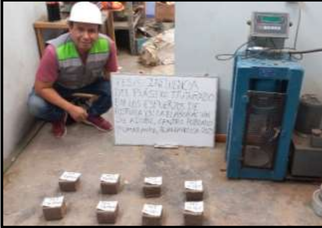
Especímenes (muestras) de adobe sin y con adición de plástico triturado (PET)
