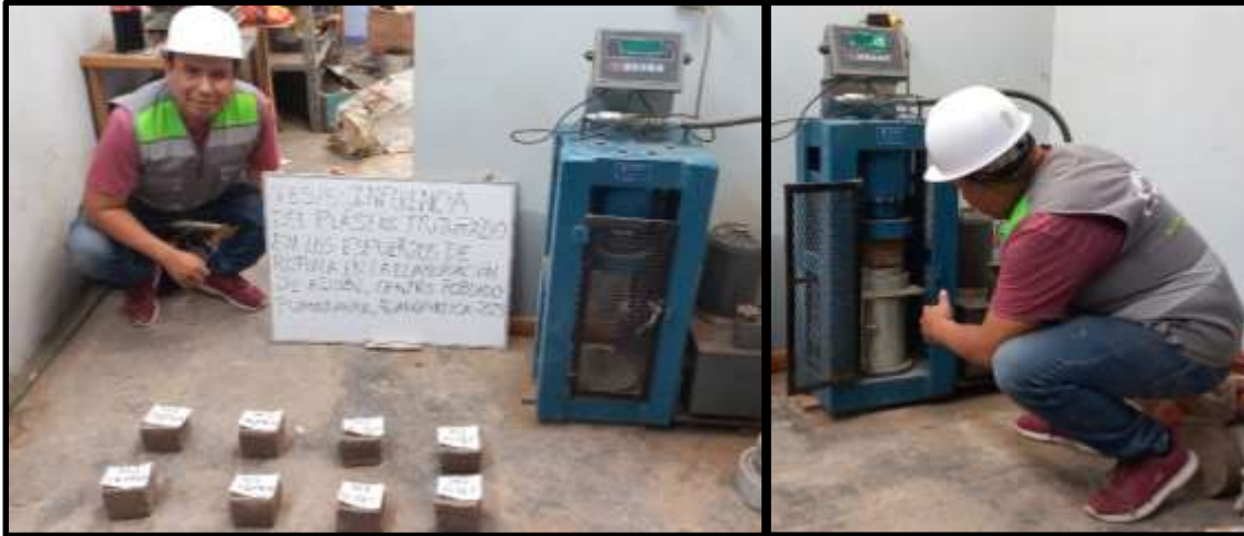
Figura 30. Ensayos de laboratorio (cubos de adobe).
