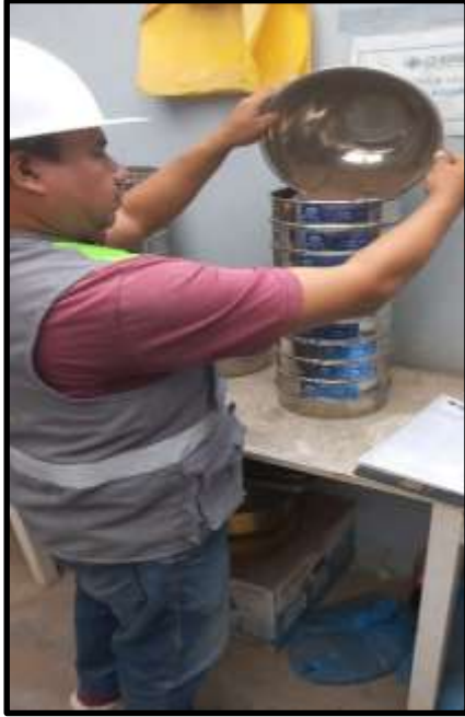
Tamizado del material extraído
