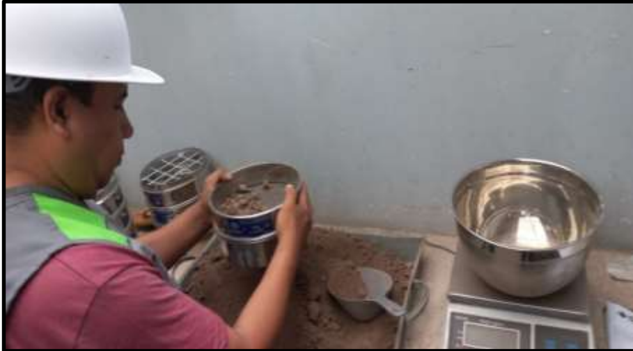
Figura 23. Material (muestra del suelo) pasando por las mallas.
