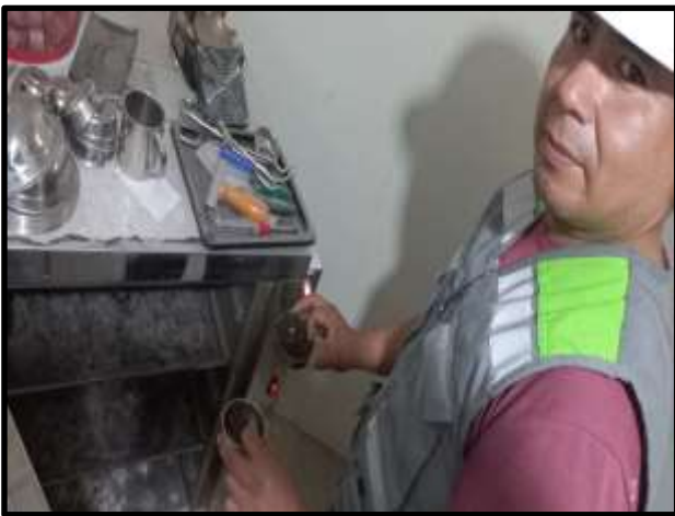
Secado de la muestra en el horno
