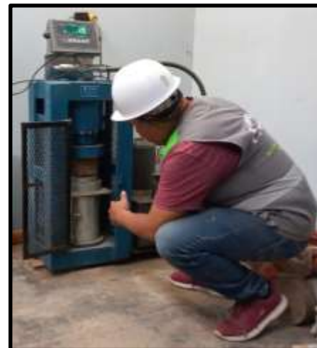
Ensayos de compresión en laboratorio (cubos de adobe)
