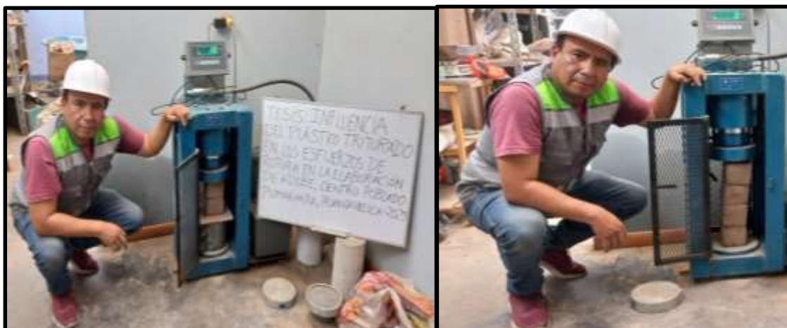
Figura 32. Ensayos de laboratorio (pilas de adobe).
