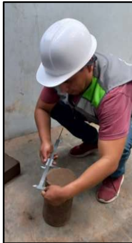
Medición de los especímenes (muestras)
