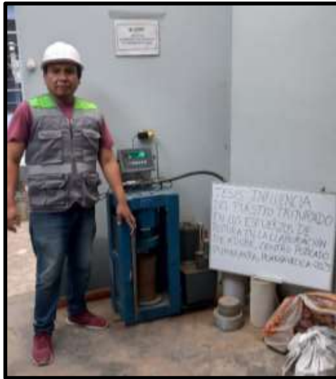
Ensayos de tracción en laboratorio (cilindro de adobe)
