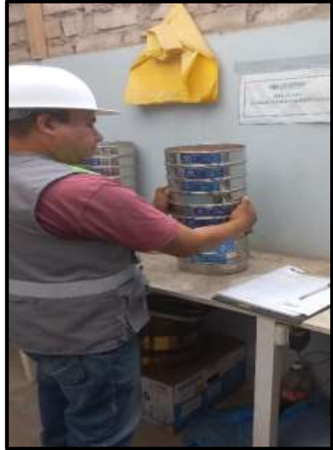
Tamizado del material extraído
