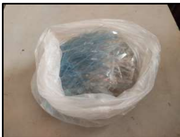
Figura 25. Plástico triturado para adicionar al adobe patrón.
