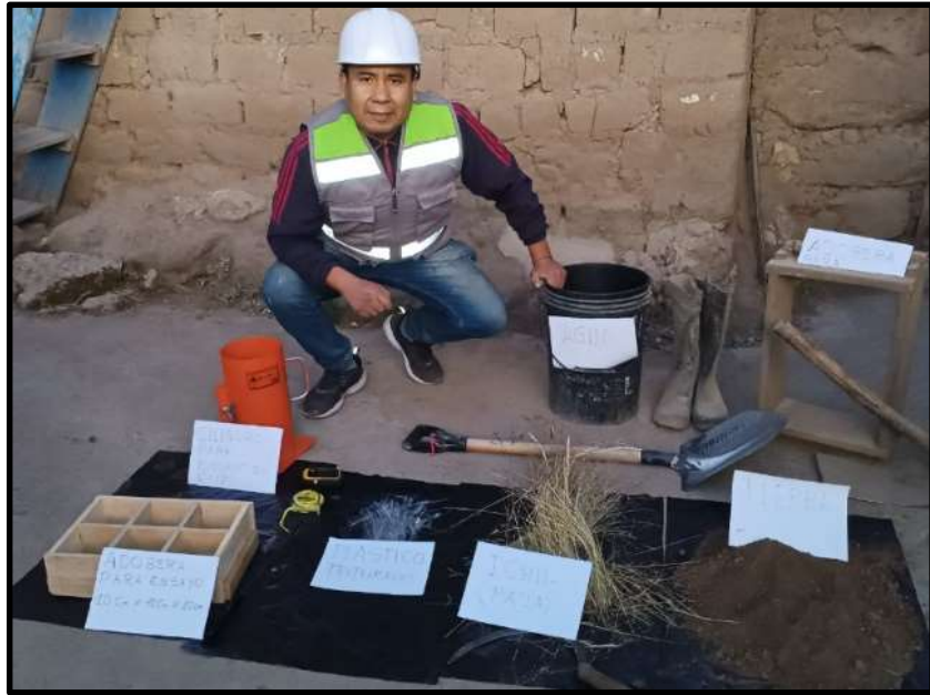
Implementos para extracción de muestra
