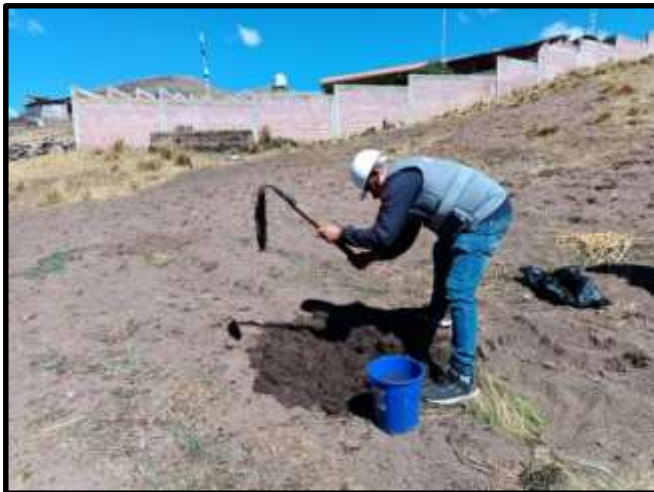
Extracción del material para la elaboración de los especímenes (muestras) de adobe
