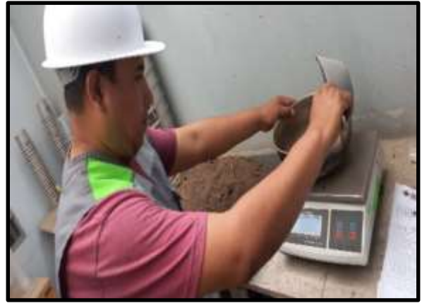
Realizando los análisis granulométricos del material extraído
