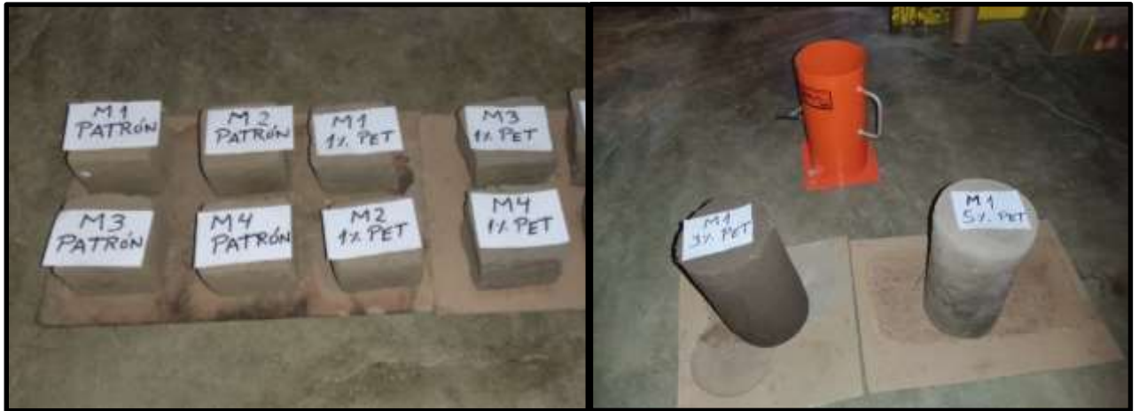
Figura 28. Adobes listos para los ensayos de laboratorio.
