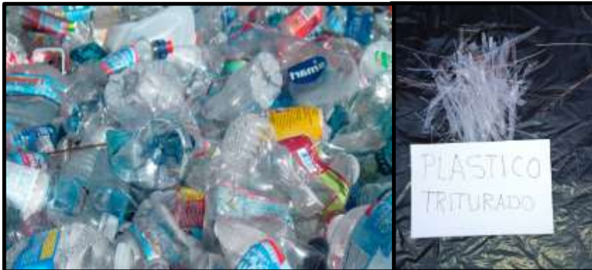
Figura 14. Selección y trituración de las botellas de plástico.
