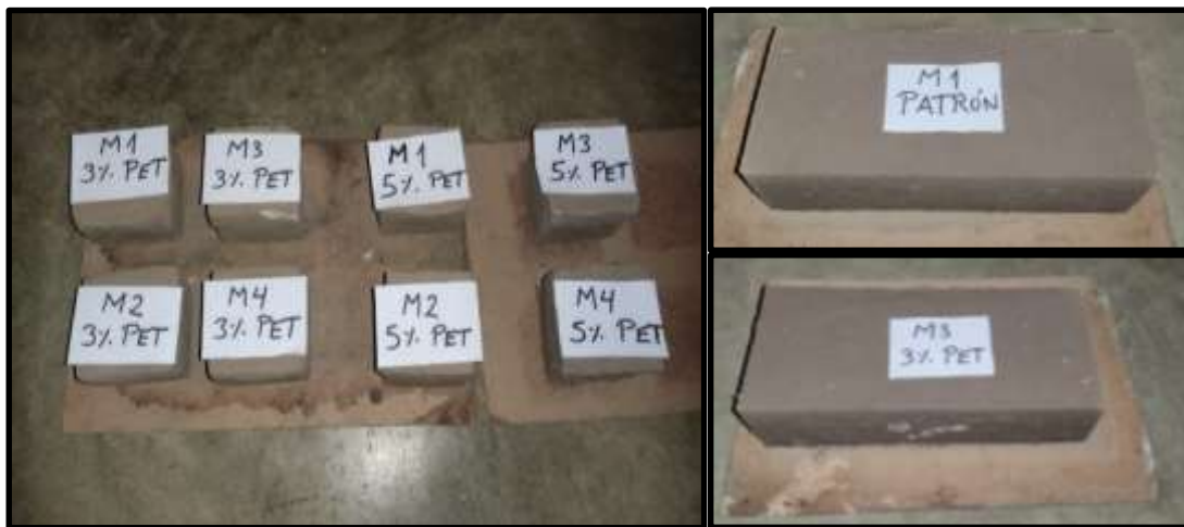
Figura 29. Adobes listos para los ensayos correspondientes de laboratorio.
