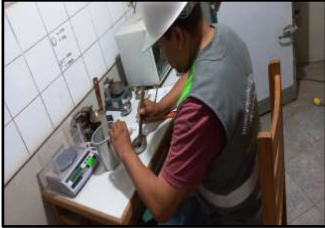
Límites de consistencia de la muestra
