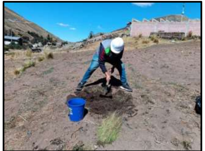
Extracción del material para la elaboración de los especímenes (muestras) de adobe
