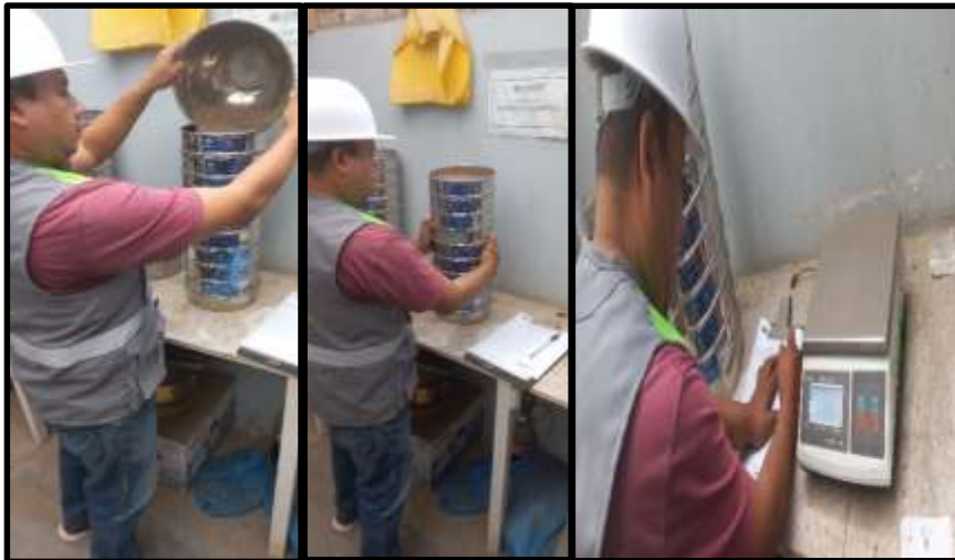
Figura 24. En laboratorio realizando el ensayo granulométrico.
