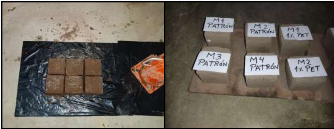
Figura 19. Preparación del adobe patrón adicionando plástico triturado.
