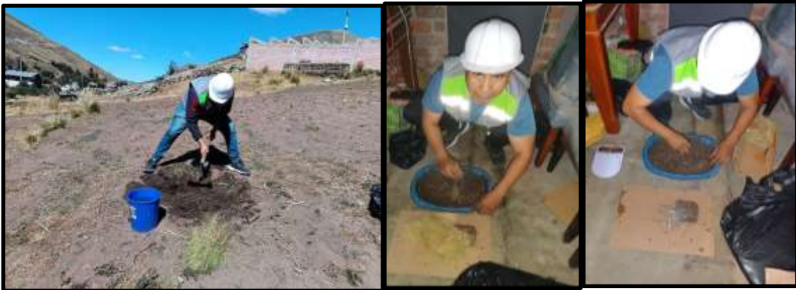
Figura 27. Mezcla con los materiales al adobe patrón y su adición de plástico triturado.
