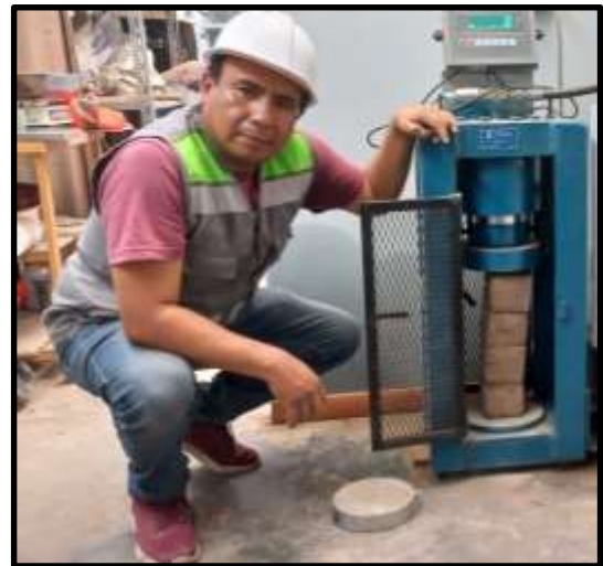
Ensayos de compresión en laboratorio (pilas de adobe)
