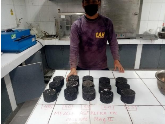
Figura 9: Briquetas con diferentes dosificaciones de asfalto
