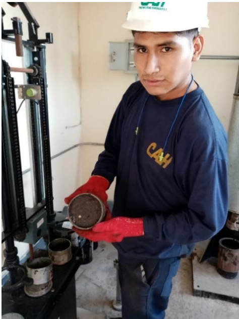
Figura 10: Martillo compactador marshall.
