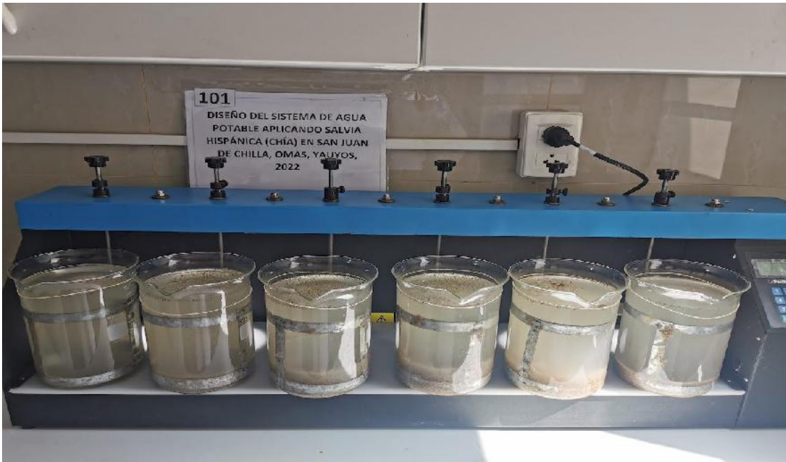
Figura N° 4: prueba de jarras con su seis componente de precipitado
