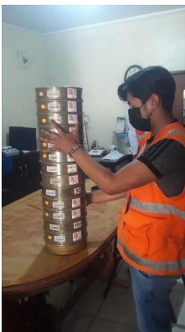
**Figura.4** Tamizado del material muestra Calicata N°1
