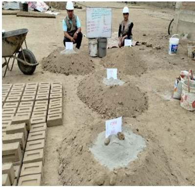
Medida del polvo de concreto reciclado en porcentajes para mezclar con la tierra.
