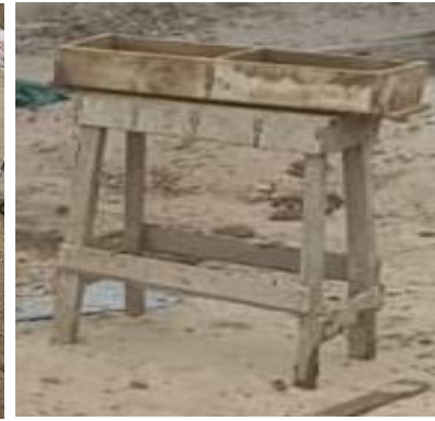
La gabera debe de ser mojada antes de producir los adobes.
