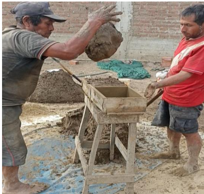
La mezcla se convierte en bolas de barro y se lo suelta para un moldeo uniforme.
