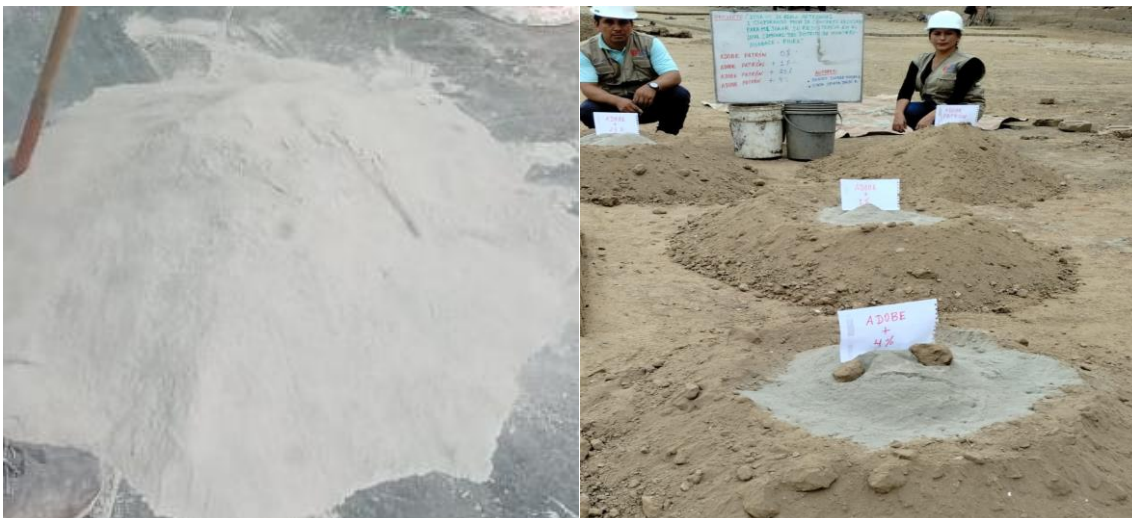
Imagen N°3: Polvo de concreto de reciclado y tierra con porcentajes.
