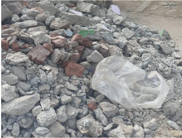
Concreto de estructuras demolidas.
