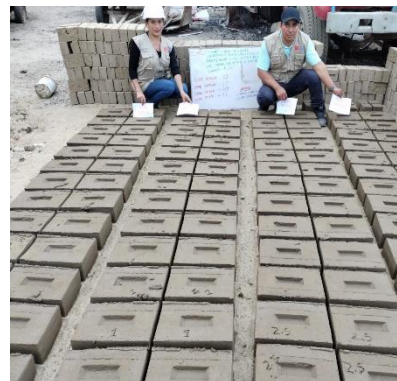
Secado del adobe con sus diferentes porcentajes de polvo de concreto reciclado.
