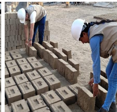
Levantado del adobe en posición de lado para que tenga un secado uniforme, después de 20 días.
