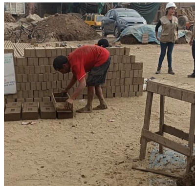
Proceso del adobe vaciado del molde para su secado, evitando su deformación física.
