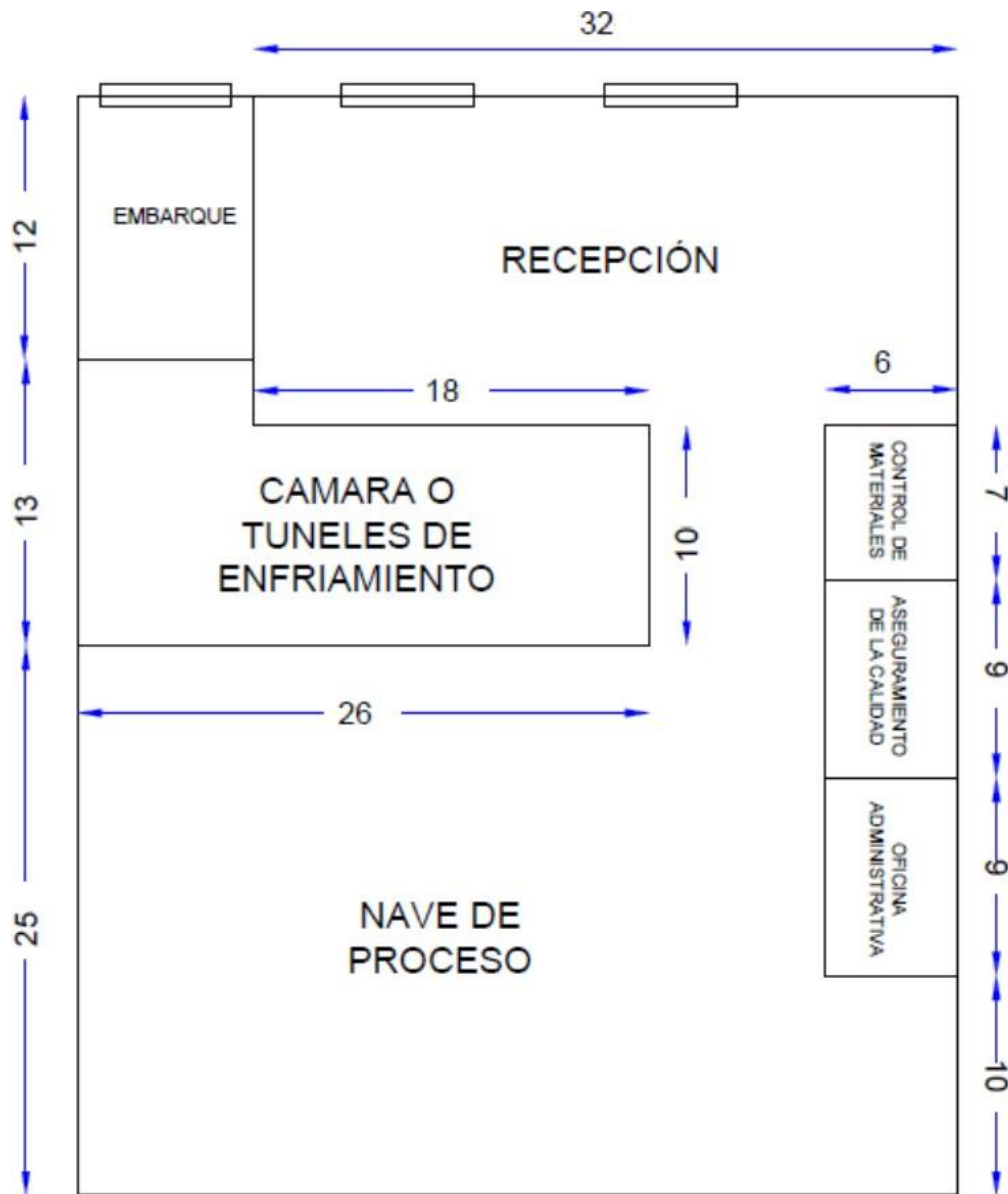
Figura 5. Modelo de distribución de una planta de mermeladas
