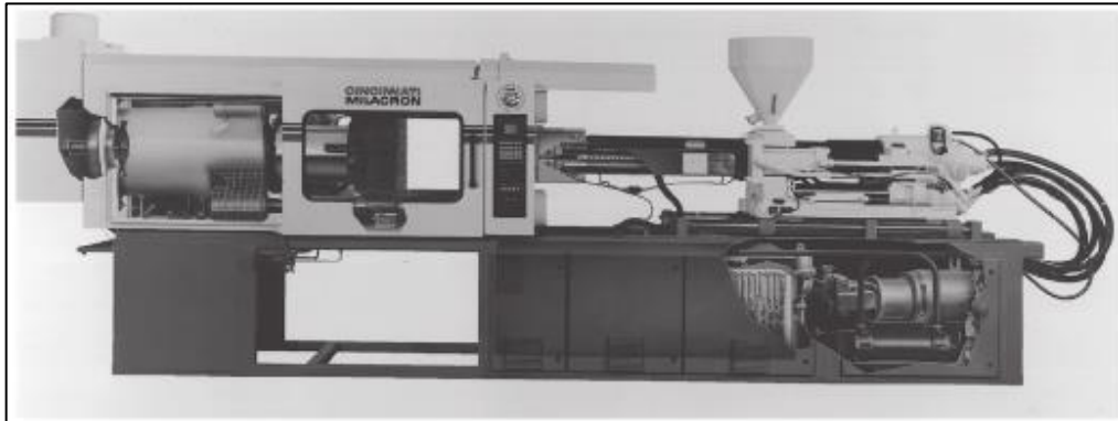
Figura 1 Máquina de inyección de plástico horizontal
