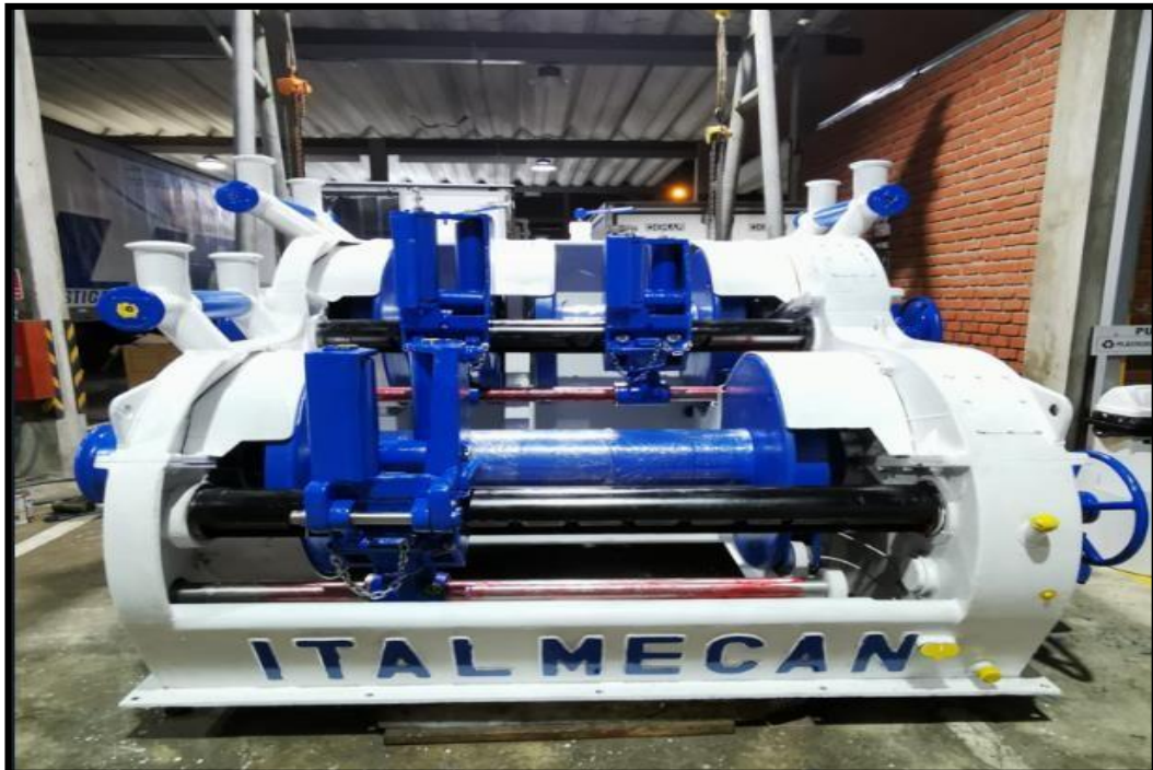
Figura 7: WINCHE DE PESCA MODELO ITALMECAN IT-25 (después de su mantenimiento).
