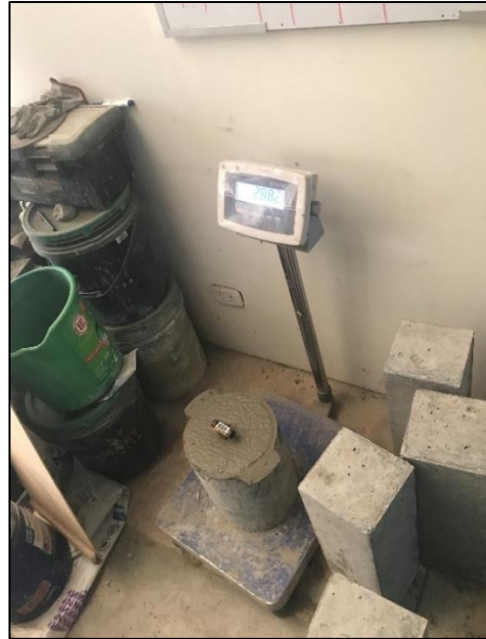
Foto 24: Preparación de la probeta para el ensayo del tiempo de fraguado.
