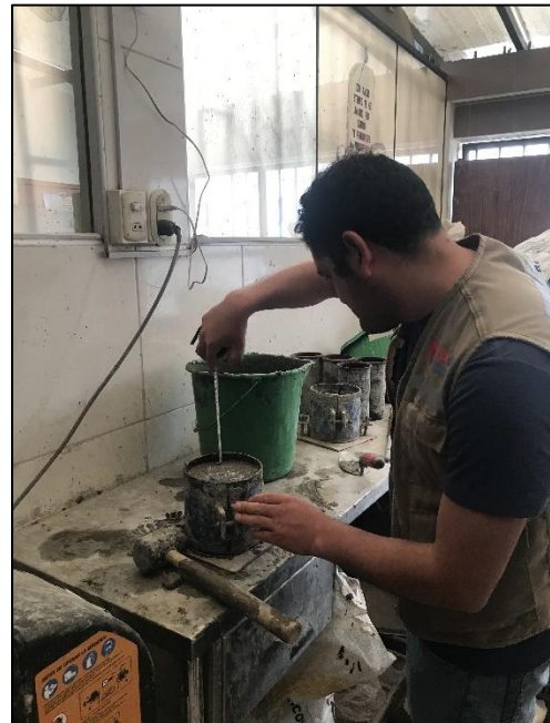
Foto 24: Preparación de la probeta para el ensayo del tiempo de fraguado.
