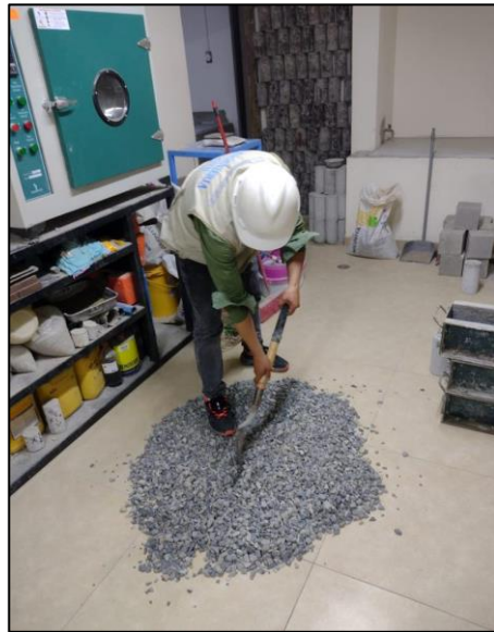
Foto 8: Peso unitario seco compactado del material fino
