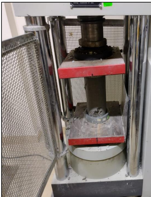
Foto 19: Probeta sometida a fuerza de compresión, en prensa hidráulica.
