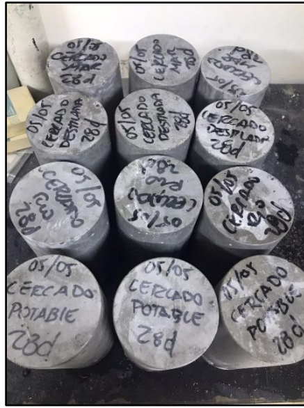
Foto 20: Probetas elaboradas con diferentes tipos de agua ensayadas.
