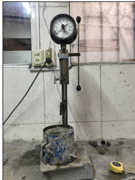
Foto 28: Probeta ensayada para tiempo de fraguado con el penetrómetro.
