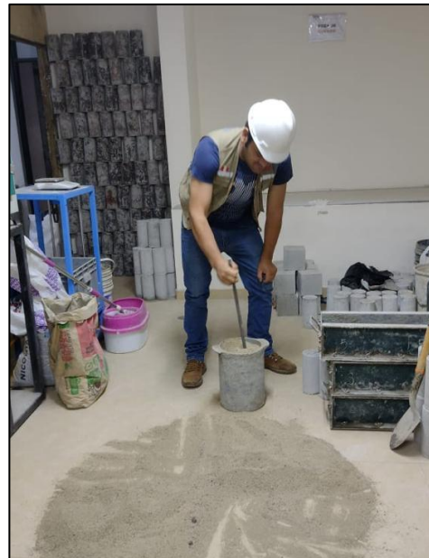
Foto 8: Peso unitario seco compactado del material fino
