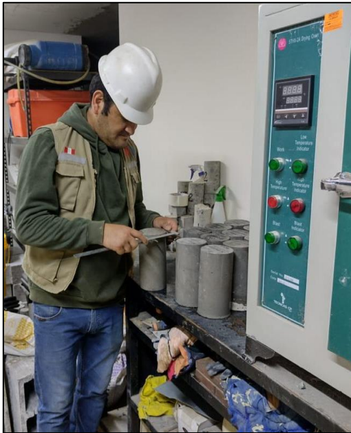
Foto 15: Comprobación de medida del diámetro de las probetas.
