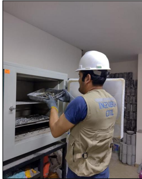
Foto 16: Probetas a 7 días de curado, para ser ensayadas a compresión.
