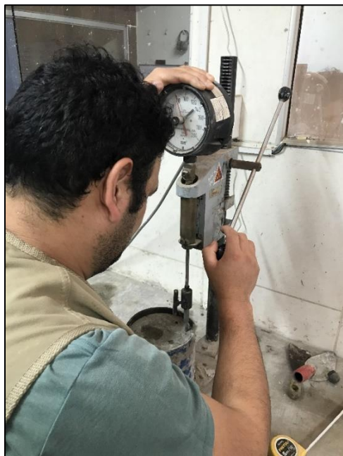
Foto 27: Ensayo de penetración con aguja de menor diámetro.
