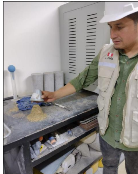
Foto 12: Material fino, saturado superficialmente seco o triple S.
