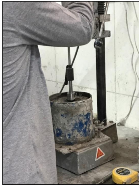
Foto 28: Probeta ensayada para tiempo de fraguado con el penetrómetro.
