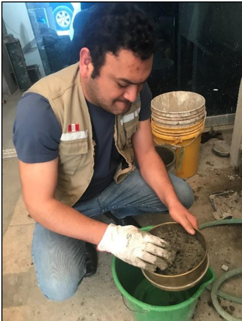
Foto 23: Tamizado al concreto para la obtención de mortero.
