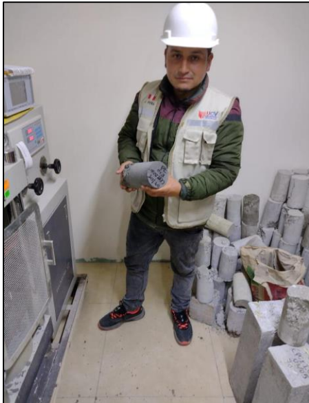
Foto 19: Probeta sometida a fuerza de compresión, en prensa hidráulica.
