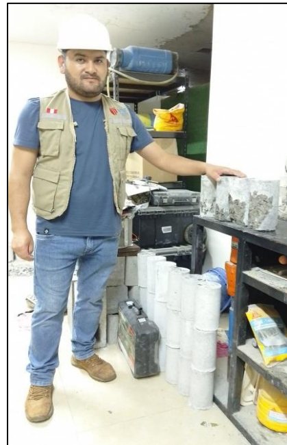
Foto 20: Probetas elaboradas con diferentes tipos de agua ensayadas.
