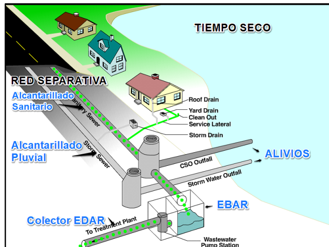
Figura 1. Sistemas de drenaje sanitario y drenaje pluvial
