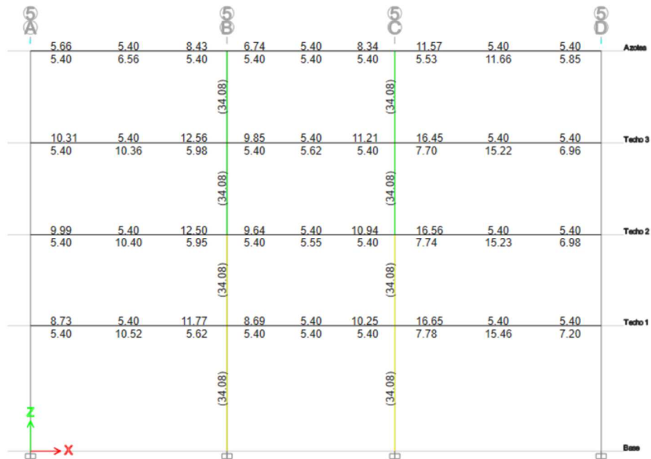
Figura 62. Area de acero longitudinal en columnas.
