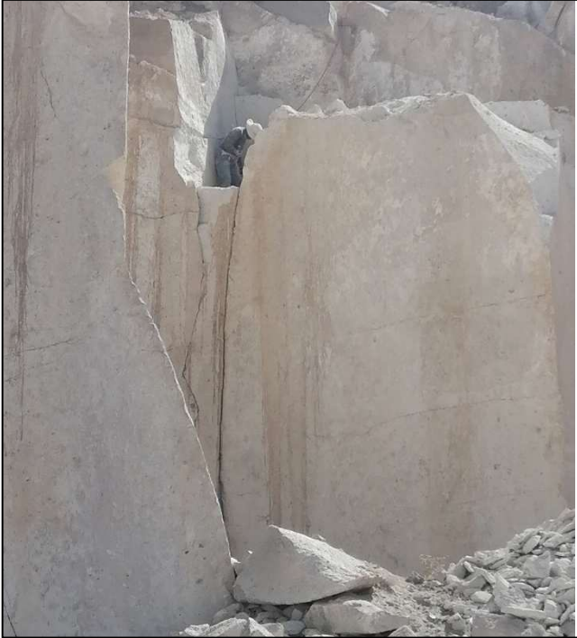
Figura 4. Extracción de los bloques de sillar de las paredes de la quebrada.
