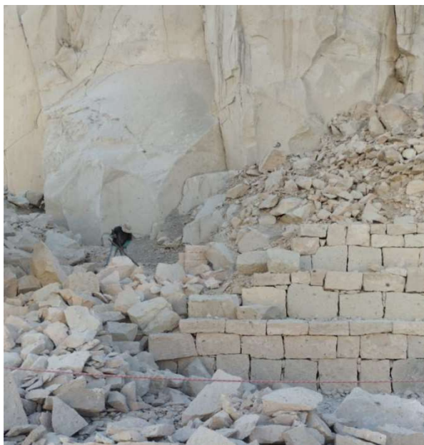
Figura 6. Extracción del sillar en bloques
