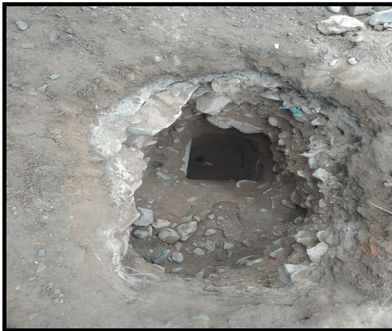
Figura 31: Excavación de calicata
