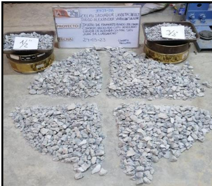
Figura 37: Cuarteo del concreto reciclado
