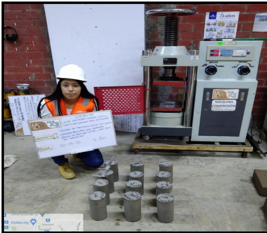
Figura 40: Rotura de probetas 7 días
