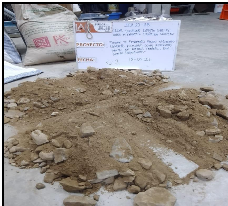
Figura 45: Cuarteo de muestra de las calicatas
