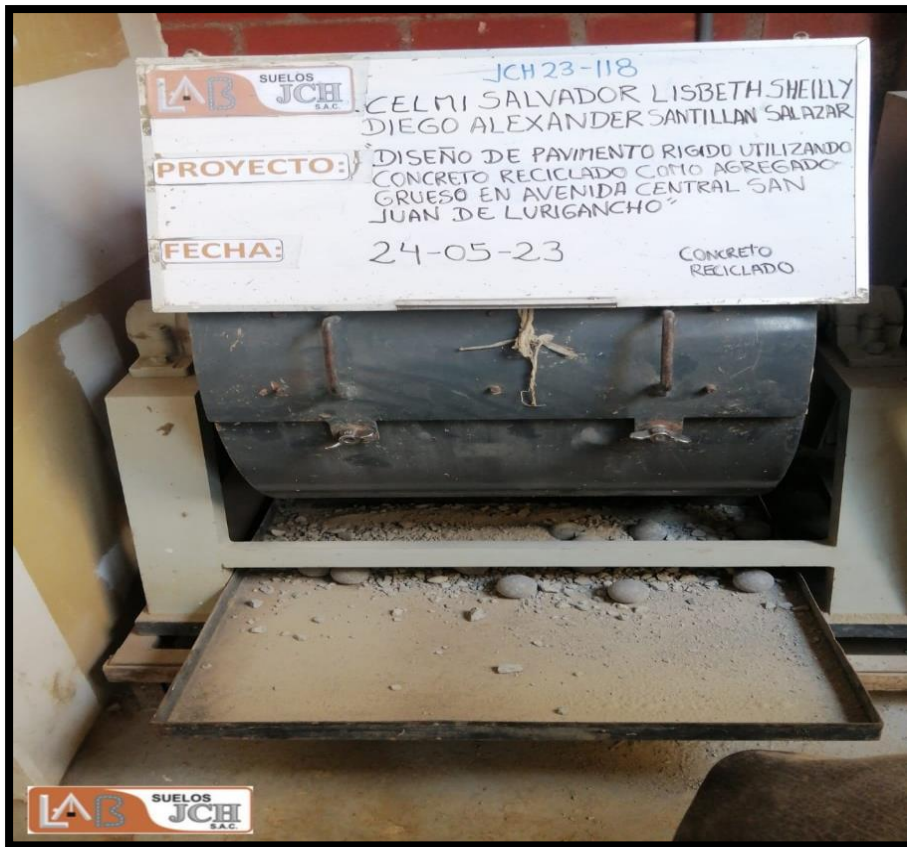
Figura 36: Ensayo de abrasión los ángeles
