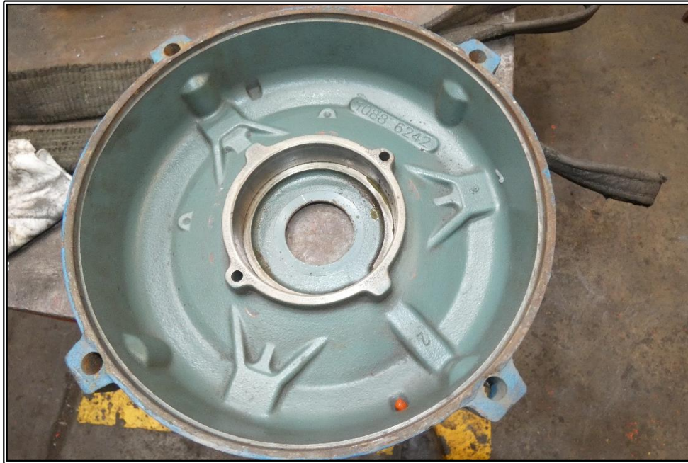
Figura D – 3: Estado físico de las tapas laterales del motor en cuestión
