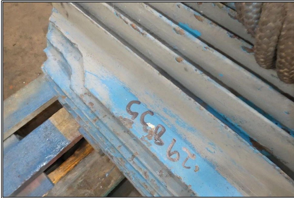
Figura D – 5: Estado físico de las aletas de refrigeración del estator
