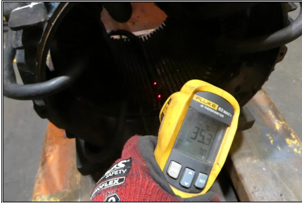
Figura B – 5: Prueba de núcleo en el estator con 10 minutos de duración
