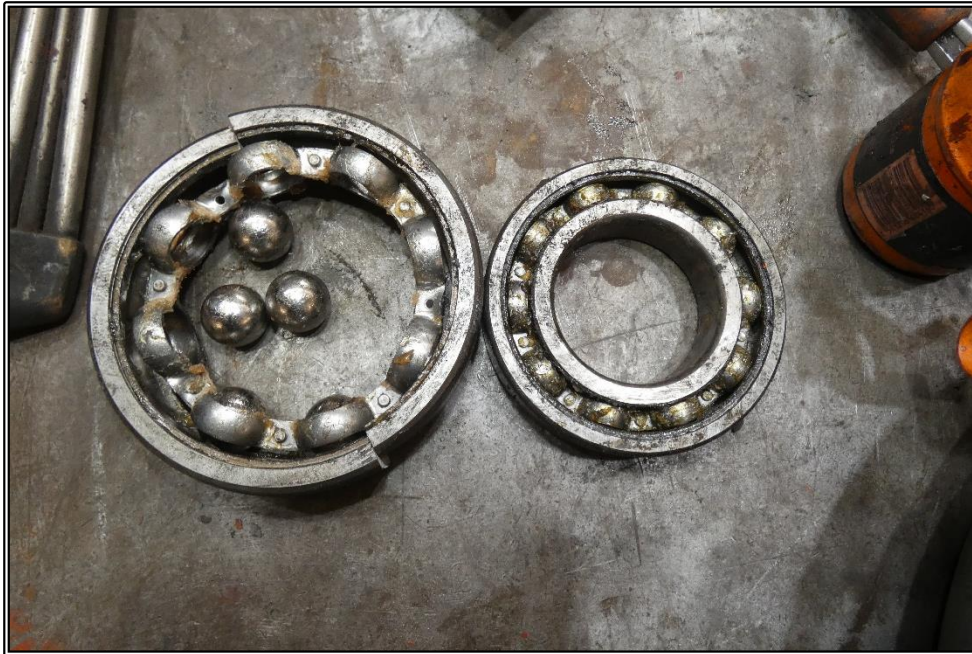
Figura D – 2: Estado físico de los rodamientos del motor en cuestión
