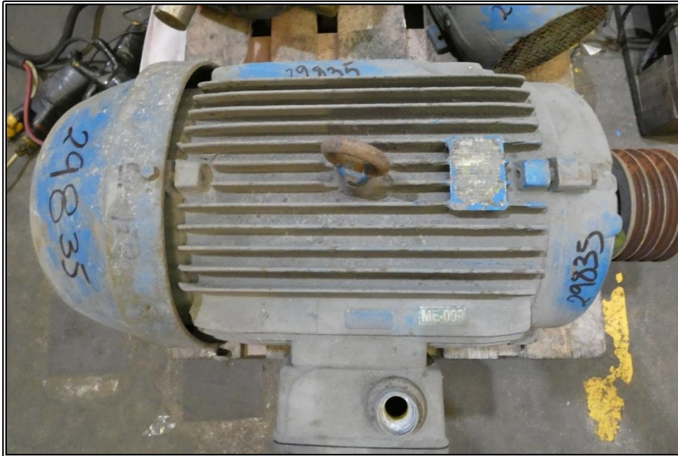
Figura B – 1: Motor eléctrico trifásico de muestra para la investigación
