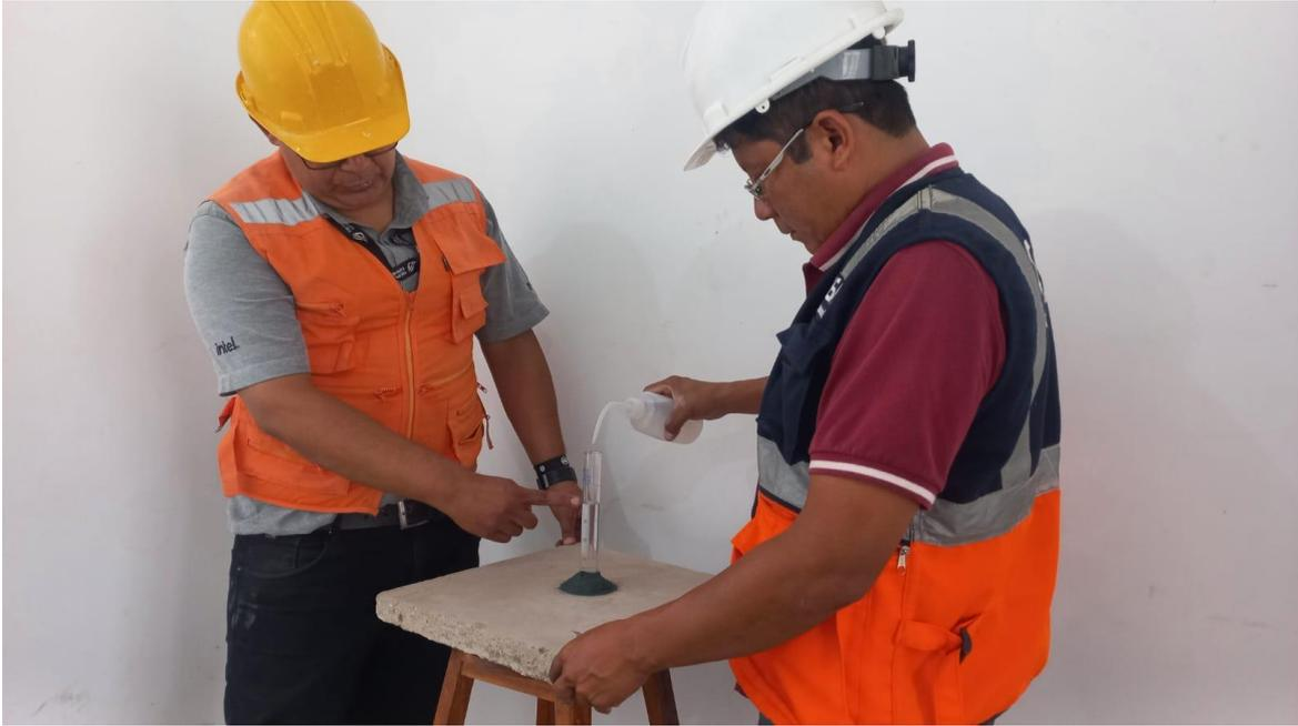
**Ensayo con Tubo de Karsten sin impermeabilizar la muestra**
