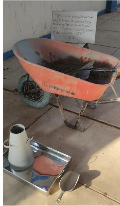
**Mezcla de los materiales para un concreto  $f'c=210$  kg/cm<sup>2</sup>**
