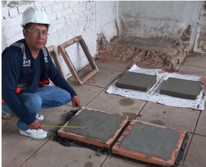
Figura 5. Proceso de vaciado de probetas.
