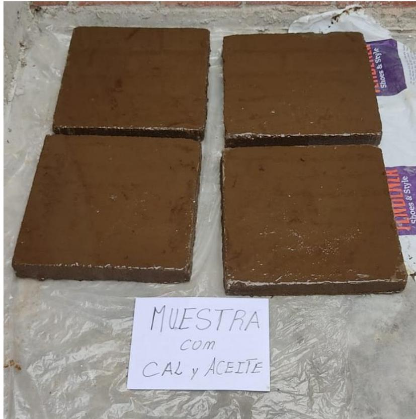
**Peso de las muestras con método de contenido de humedad y calculo de porcentaje de permeabilidad.**
