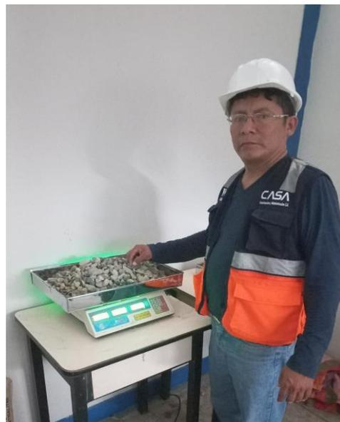
**Peso de los materiales para el diseño de mezcla**
