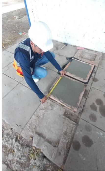
**Elaboración de muestras para ensayos de impermeabilización.**
