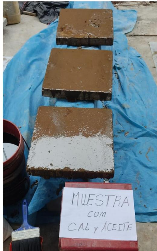
**Aplicación de impermeabilizante con cal y aceite residual.**
