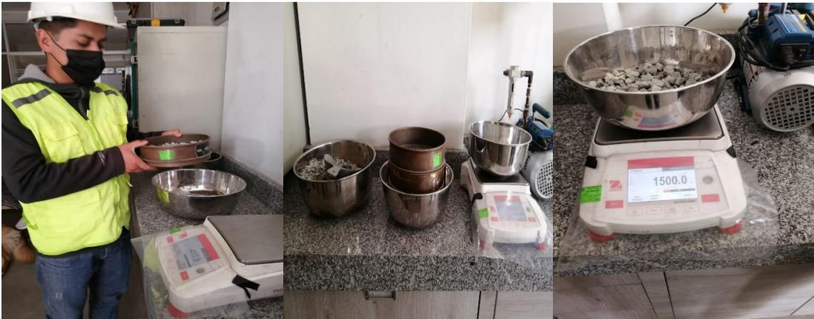
Dosificación de la mezcla por el método ACI. Se realizó en las instalaciones del laboratorio GEOCONTROL PERÚ SAC que se ubica en el distrito de Ate, provincia y departamento de Lima.
