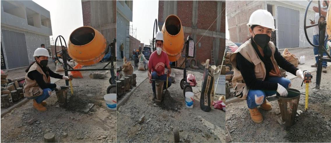
Realizando ensayos de asentamiento (Slump)
