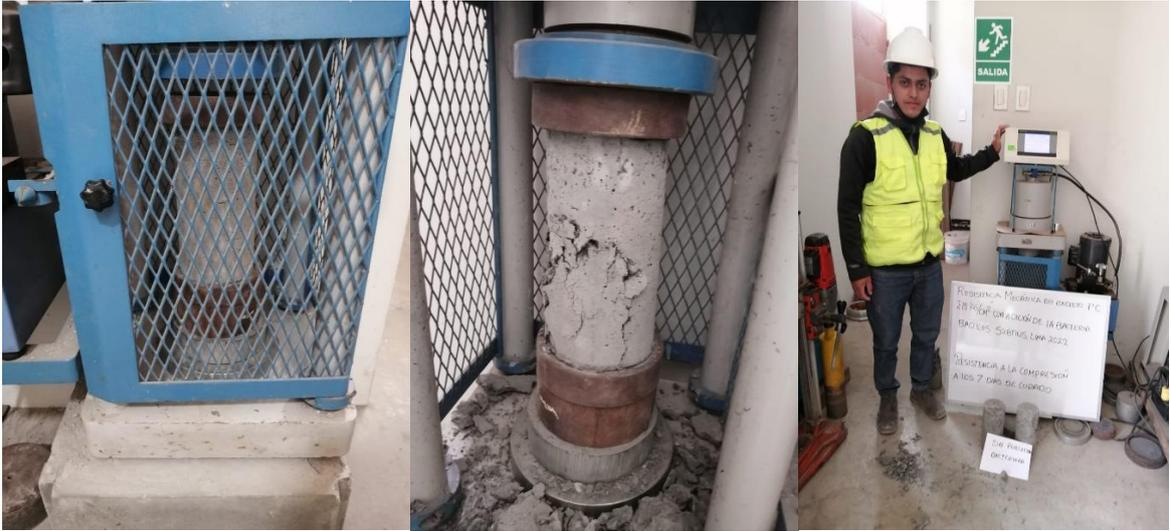
Ensayo de resistencia a la compresión.
