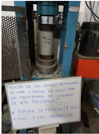
Rotura del concreto a compresión a los 7 días de curado con 0.5% cenizas de cascarilla de café +0.5% cenizas de coco.
