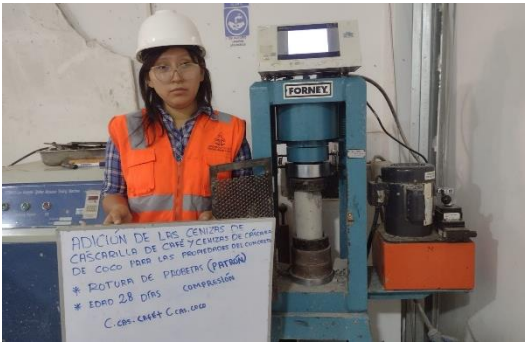
Rotura del concreto a compresión a los 28 días de curado muestra patrón
