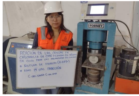
Rotura del concreto a tracción a los 14 días de curado con 0.04% cenizas de cascarilla de café +0.04% cenizas de coco.
