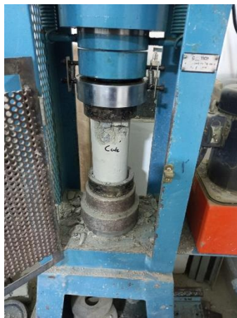
Rotura del concreto a compresión a los 7 días de curado muestra patrón.
