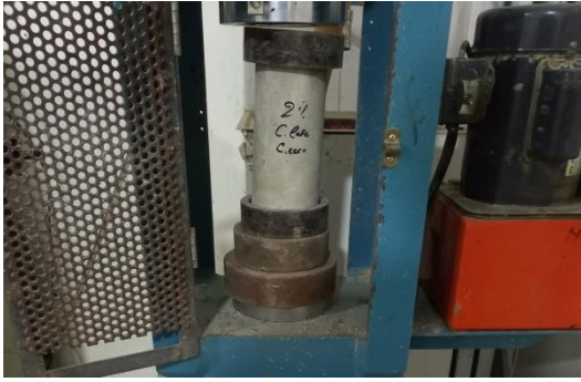
Rotura del concreto a compresión a los 14 días de curado con 1% cenizas de cascarilla de café +1% cenizas de coco.
