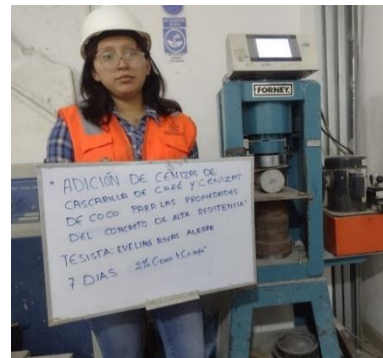
Rotura del concreto a tracción a los 7 días de curado con 1% cenizas de cascarilla de café +1% cenizas de coco.
