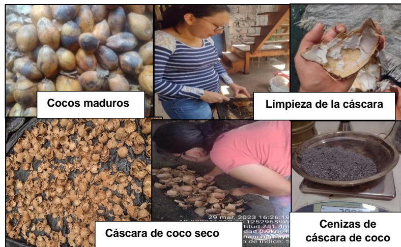
Figura 4. Proceso de obtención de cenizas de coco.
