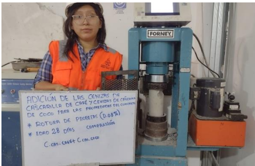
Rotura del concreto a compresión a los 28 días de curado con 0.04% cenizas de cascarilla de café +0.04% cenizas de coco.
