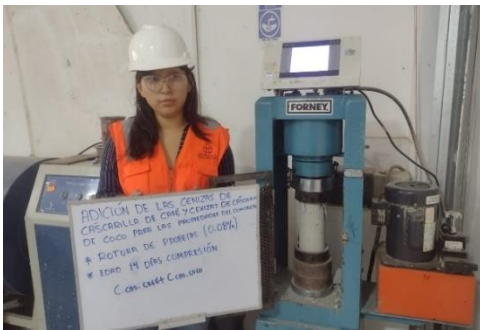
Rotura del concreto a compresión a los 14 días de curado con 0.04% cenizas de cascarilla de café +0.04% cenizas de coco.
