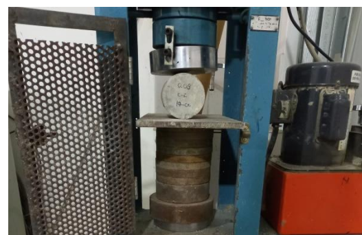
Rotura del concreto a tracción a los 28 días de curado con 0.04% cenizas de cascarilla de café +0.04% cenizas de coco.
