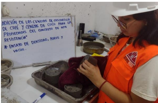
Se seco la superficie de la probeta de concreto para luego pesarlas.
