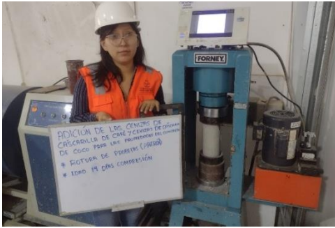
Rotura del concreto a compresión a los 14 días de curado muestra patrón.
