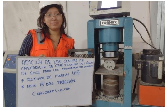
Rotura del concreto a tracción a los 28 días de curado con 0.5% cenizas de cascarilla de café +0.5% cenizas de coco.
