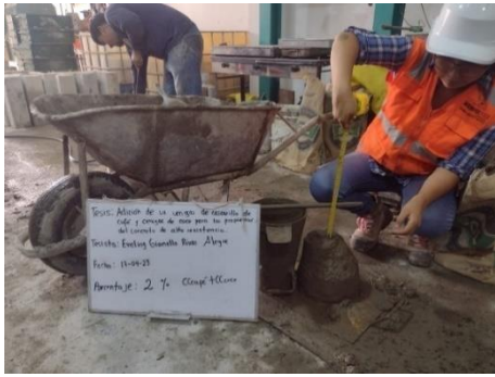
Asentamiento del concreto con 1% cenizas de cascara de café +1% cenizas de coco.
