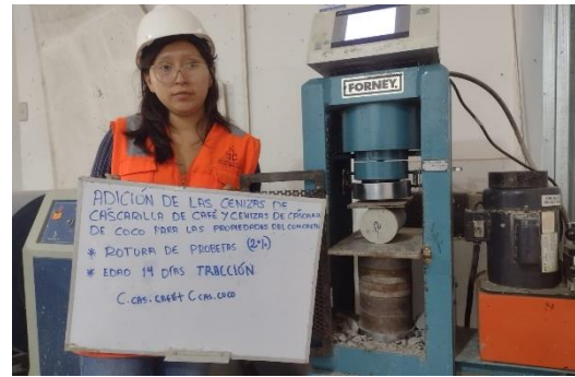
Rotura del concreto a tracción a los 14 días de curado con 1% cenizas de cascarilla de café +1% cenizas de coco.
