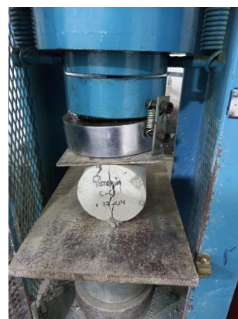
Rotura del concreto a tracción a los 7 días de curado muestra patrón.
