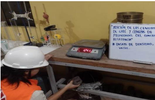
Se suspendió el espécimen y se sumerge en el agua para determinar la masa aparente.
