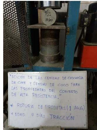
Rotura del concreto a tracción a los 7 días de curado con 0.5% cenizas de cascarilla de café +0.5% cenizas de coco.
