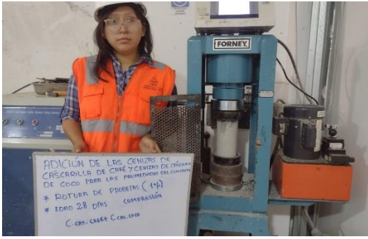
Rotura del concreto a compresión a los 28 días de curado con 0.5% cenizas de cascarilla de café +0.5% cenizas de coco.
