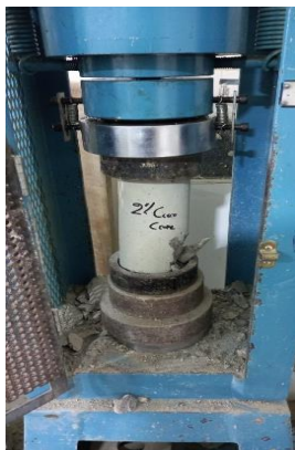
Rotura del concreto a compresión a los 7 días de curado con 1% cenizas de cascarilla de café +1% cenizas de coco.
