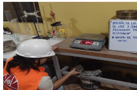
Se suspendió el espécimen y se sumerge en el agua para determinar la masa aparente.
