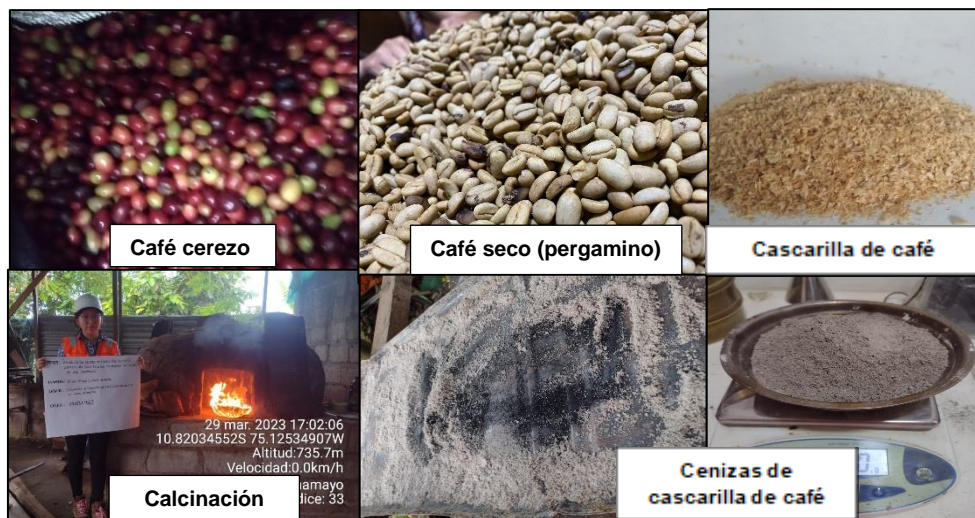
Figura 3. Proceso de obtención de cenizas de cascarilla de café.
