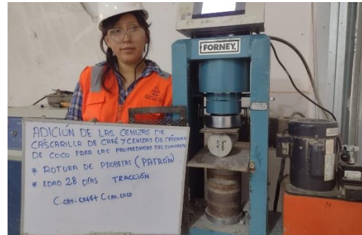
Rotura del concreto a tracción a los 28 días de curado muestra patrón
