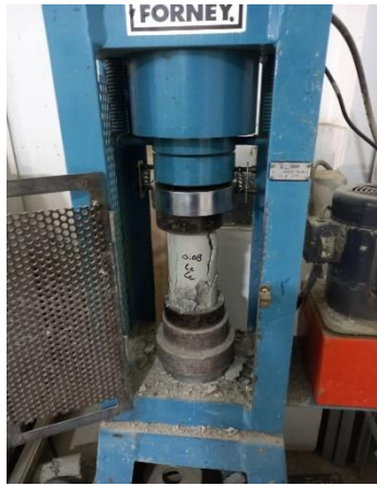
Rotura del concreto a compresión a los 7 días de curado con 0.04% cenizas de cascarilla de café +0.04% cenizas de coco.
