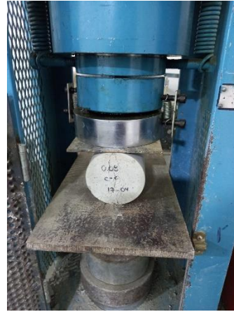
Rotura del concreto a tracción a los 7 días de curado con 0.04% cenizas de cascarilla de café +0.04% cenizas de coco.
