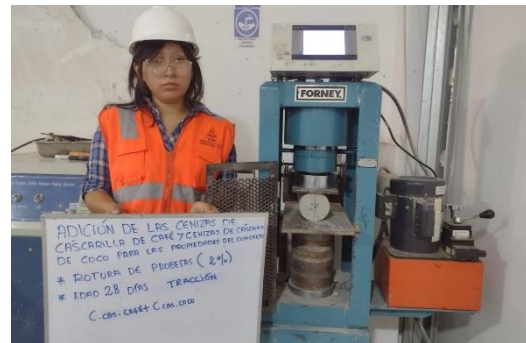
Rotura del concreto a tracción a los 28 días de curado con 1% cenizas de cascarilla de café +1% cenizas de coco.
