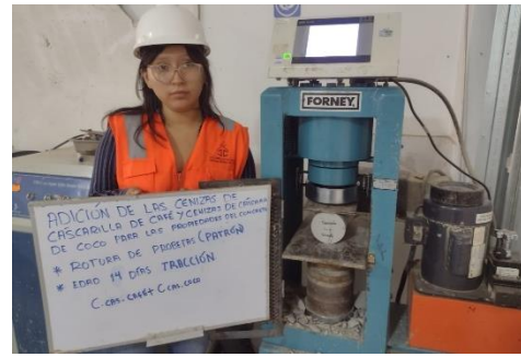
Rotura del concreto a tracción a los 14 días de curado muestra patrón.
