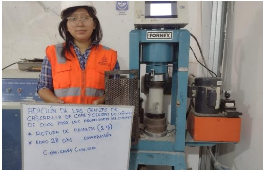
Rotura del concreto a compresión a los 28 días de curado con 1% cenizas de cascarilla de café +1% cenizas de coco.
