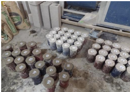
Probetas de concreto de 4"x8"
