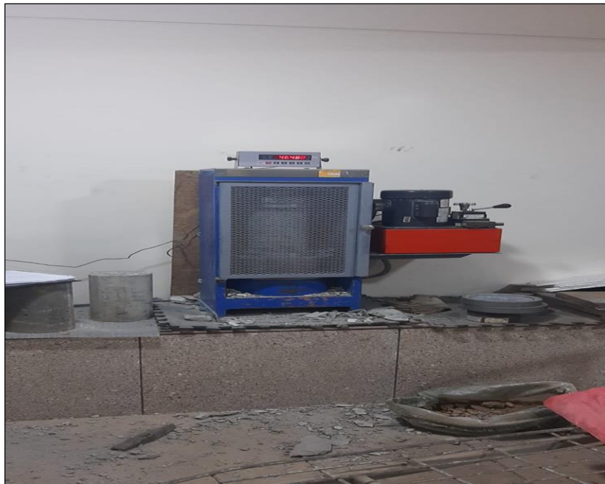
Fotografia 8. Ensayo de resistencia a la compresion del concreto.
