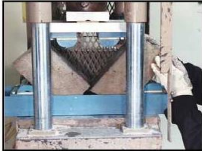
Figura 2. Ensayo de rotura de molde tipo viga.
