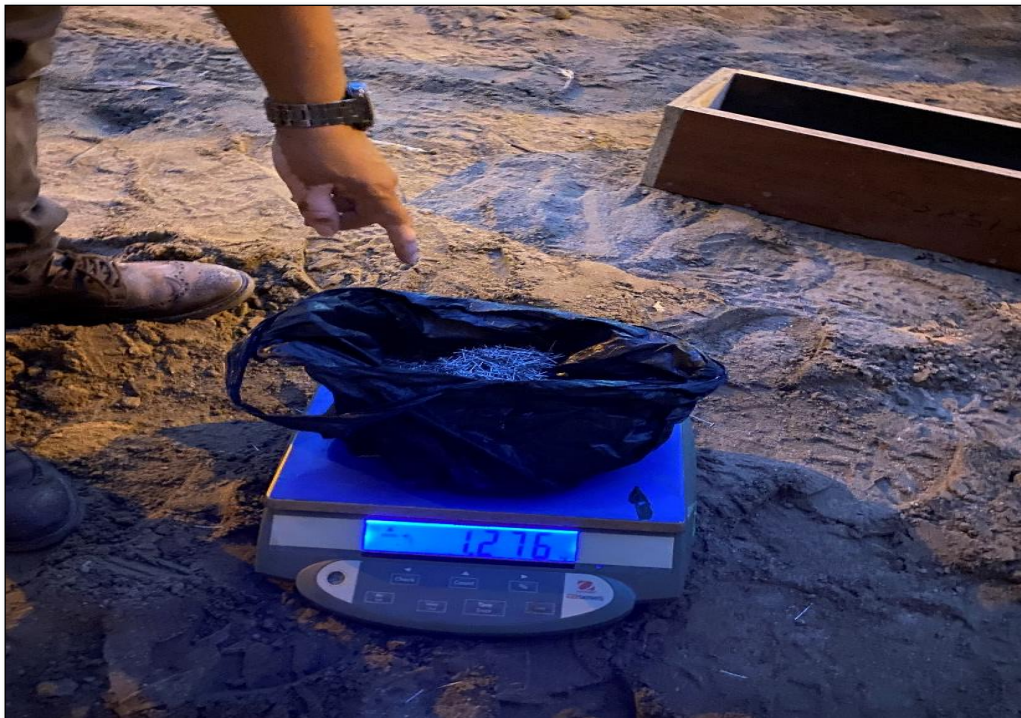
Fotografía 4. Peso de la fibra alambre galvanizado para la incorporar a la mezcla de concreto.
