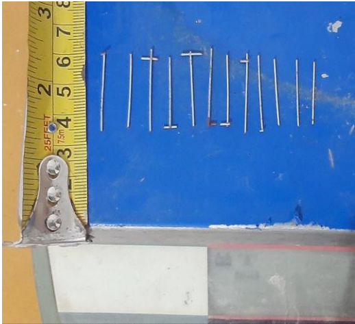
Figura 3. Fibra de acero de 3 cm tipo I.
