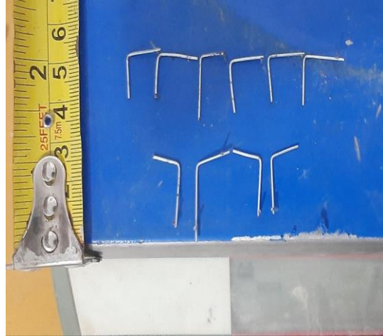
Figura 4. Fibra de acero de 3 cm tipo L.
