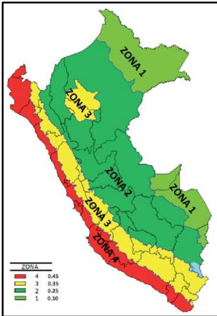
Fuente: NTP E.030 Diseño Sismorresistente
