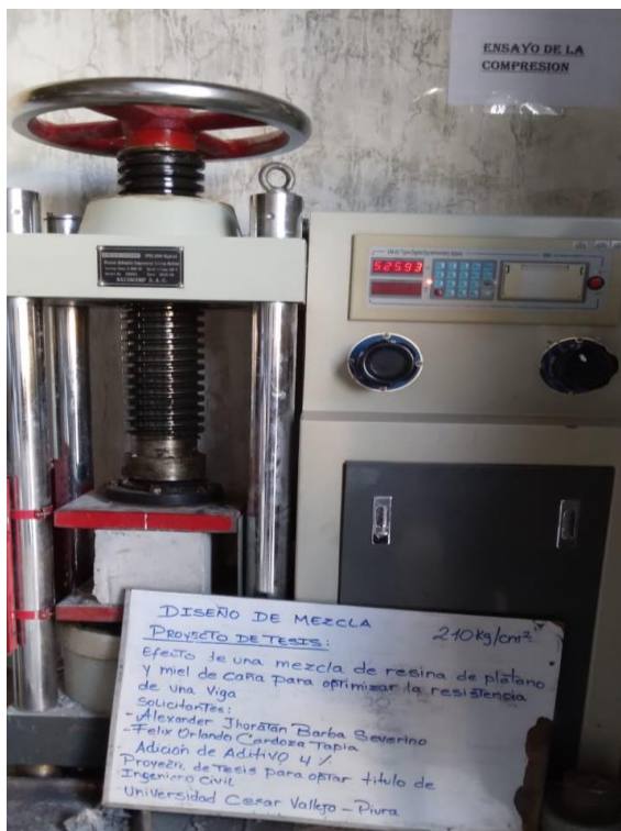
Rotura de Vigas Prismáticas a Flexión f'c=210 \text{ kg/cm}^2 – 28 días
