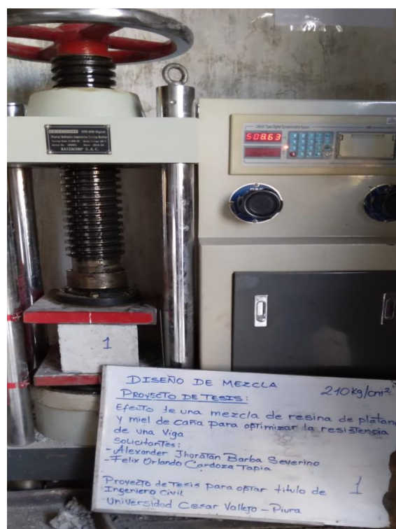
Rotura de Vigas Prismáticas a Flexión f'c=210 \text{ kg/cm}^2 – 28 días
