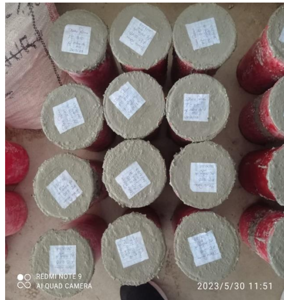
Llenado de Probetas Cilíndricas f'c=210\text{kg/cm}^2
