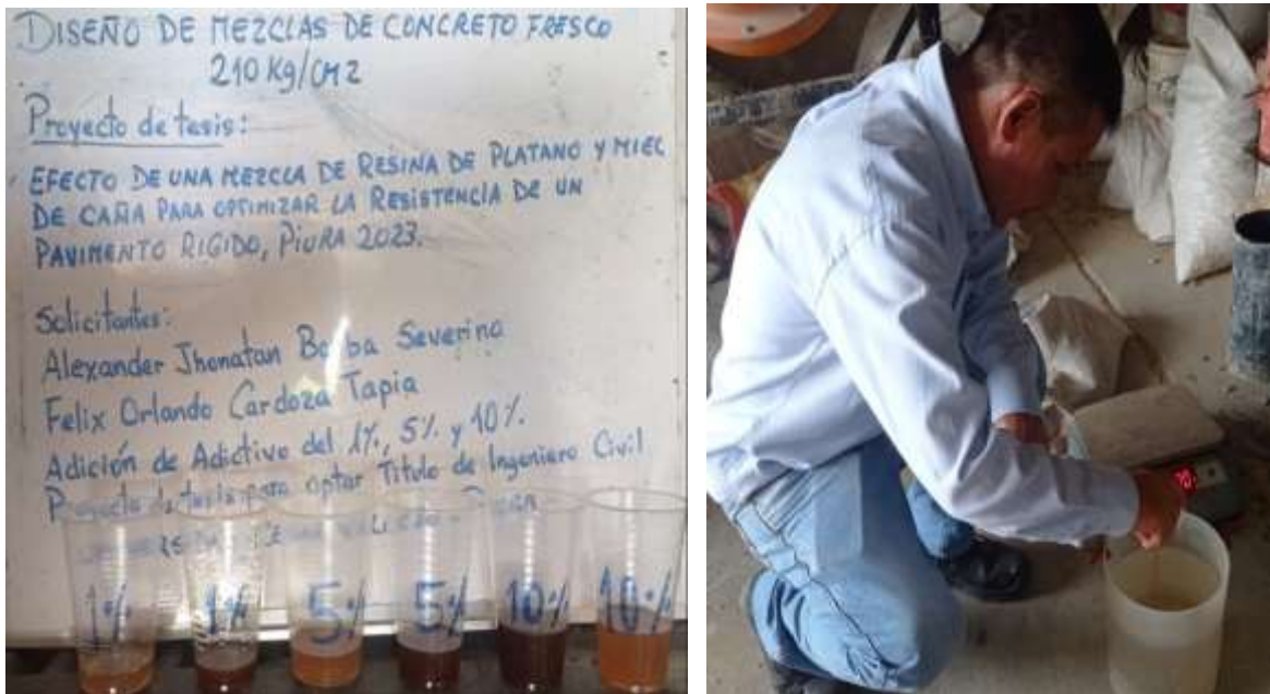
Figura N°13 – Dosificación del Aditivo de la Mezcla Resina y Miel de caña.
