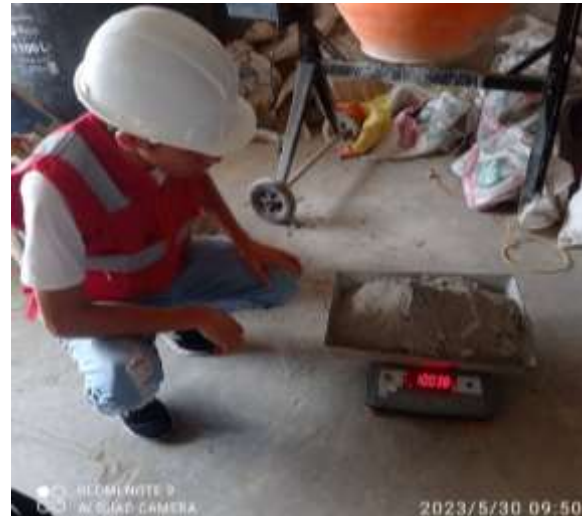
Figura N°14 – Peso de Materiales y Llenado de Probetas.
