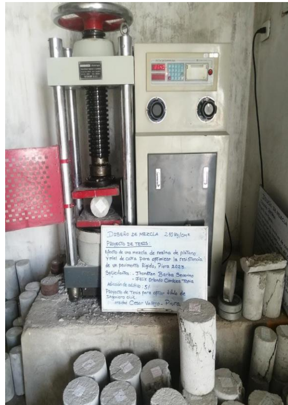
Rotura de Probetas Cilíndricas a Tracción f'_c=210 \text{ kg/cm}^2 – 7 y 14 días
