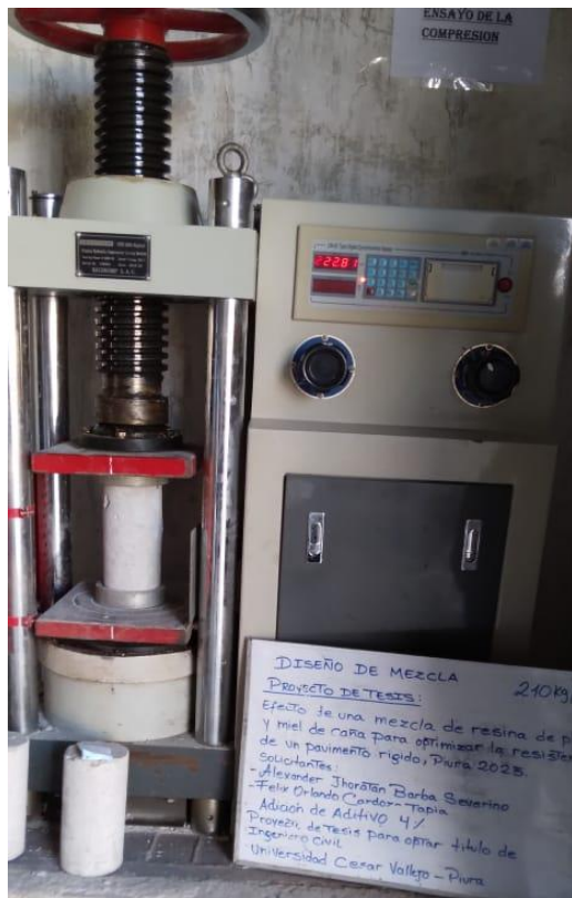
Rotura de Probetas Cilíndricas a Compresion f'_c=210 \text{ kg/cm}^2 – 28 días
