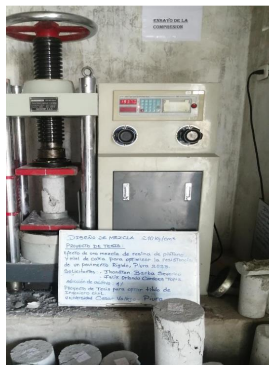
Rotura de Probetas Cilíndricas a Compresión f'c=210 \text{ kg/cm}^2 – 7 y 14 días
