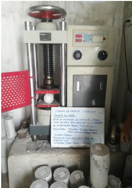
Rotura de Probetas Cilíndricas a Tracción f'_c=210 \text{ kg/cm}^2 – 7 y 14 días
