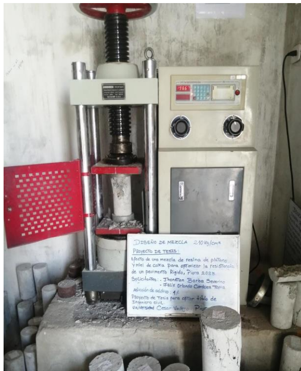
Rotura de Probetas Cilíndricas a Compresión f'c=210 \text{ kg/cm}^2 – 7 y 14 días
