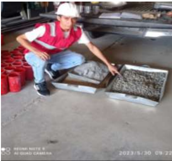
Figura N°14 – Peso de Materiales y Llenado de Probetas.
