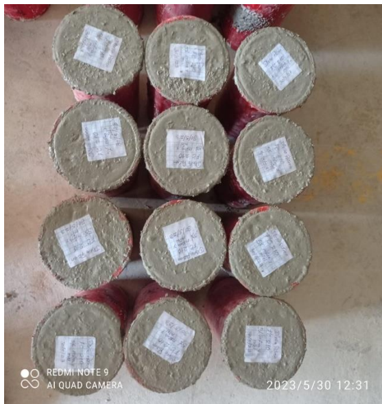
Llenado de Probetas Cilíndricas f'c=210\text{kg/cm}^2
