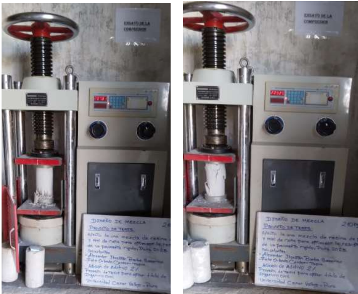
Figura N° 25 - Ensayo a compresión muestra patrón y con mezcla de resina y miel de caña.
