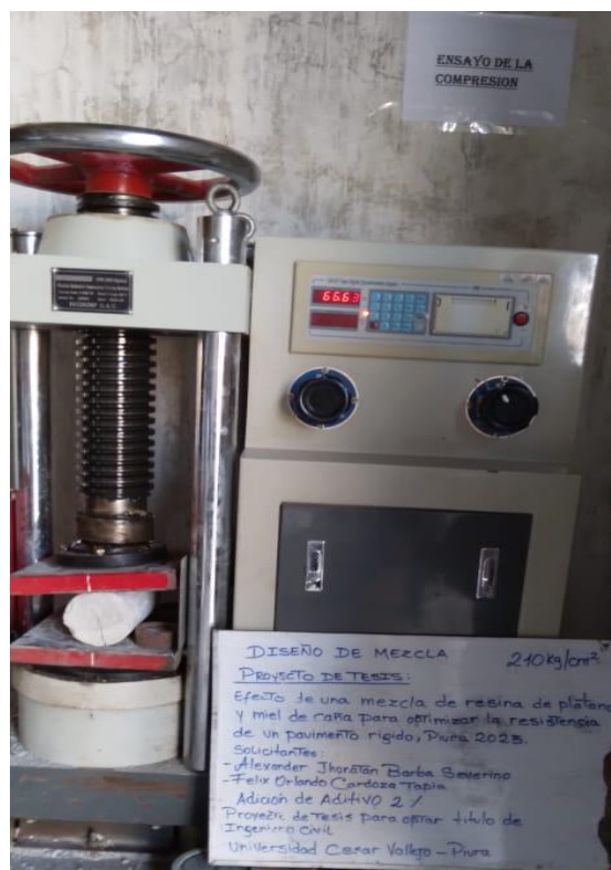
Rotura de Probetas Cilíndricas a Tracción f'_c=210 \text{ kg/cm}^2 – 28 días
