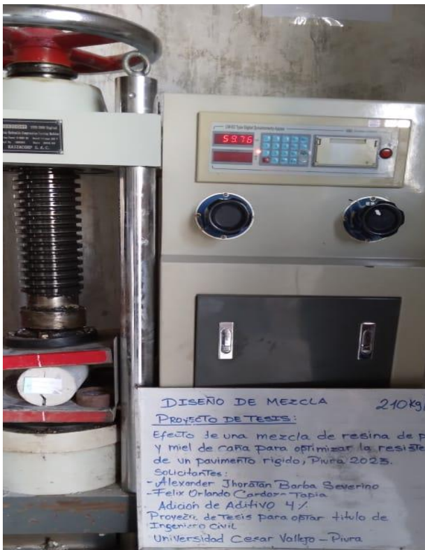
Rotura de Probetas Cilíndricas a Tracción f'_c=210 \text{ kg/cm}^2 – 28 días
