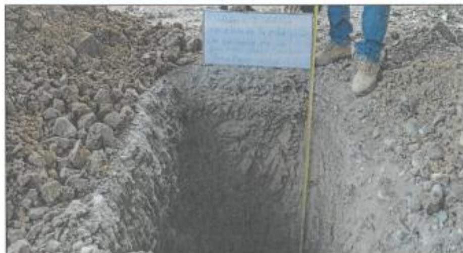
Imagen N° 04: Se aprecia el Perfil estratigráfico y tipo de suelo, la cual se registró al realizar la excavación en la Calicata 02.
