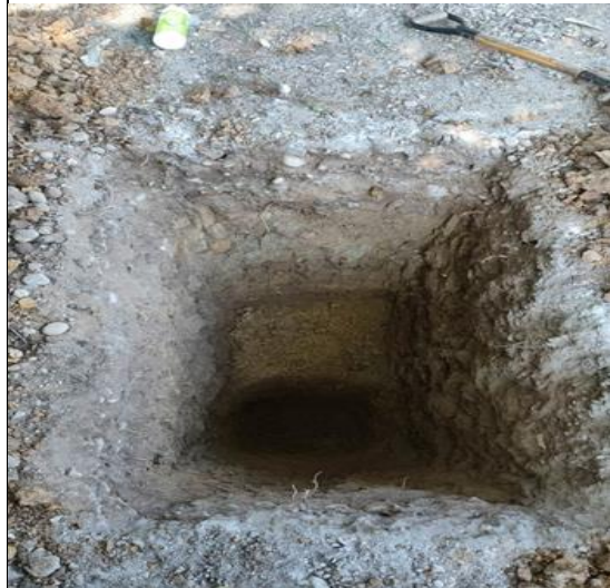
Fotografía 2. Calicata terminada de 1.50 x 1.00
