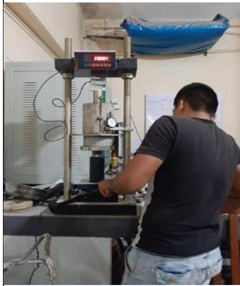
Fotografía 10. Ensayo de CBR penetración
