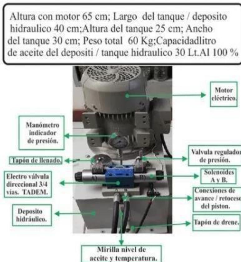
Figura 10: Módulo hidráulico
