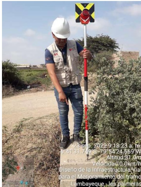
Figura 5. Ubicación de primer BM para estudio topográfico.
