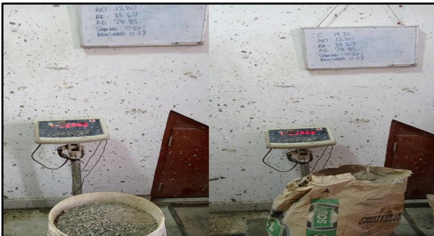
Figura 8. Pesado de los materiales convencionales para el concreto Fuente: propia
