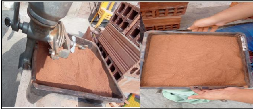
Figura 7. Proceso de molido del ladrillo Fuente: propia
