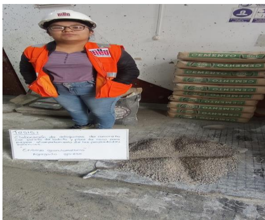
Fotografía 5. Cuarteo del agregado grueso
