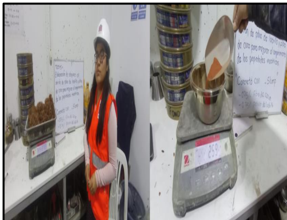
Fotografía 3. Pesado de los agregados no convencionales
