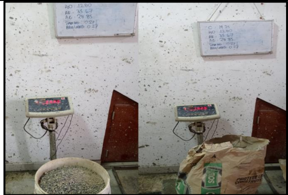
Fotografía 2. Pesado de los agregados
