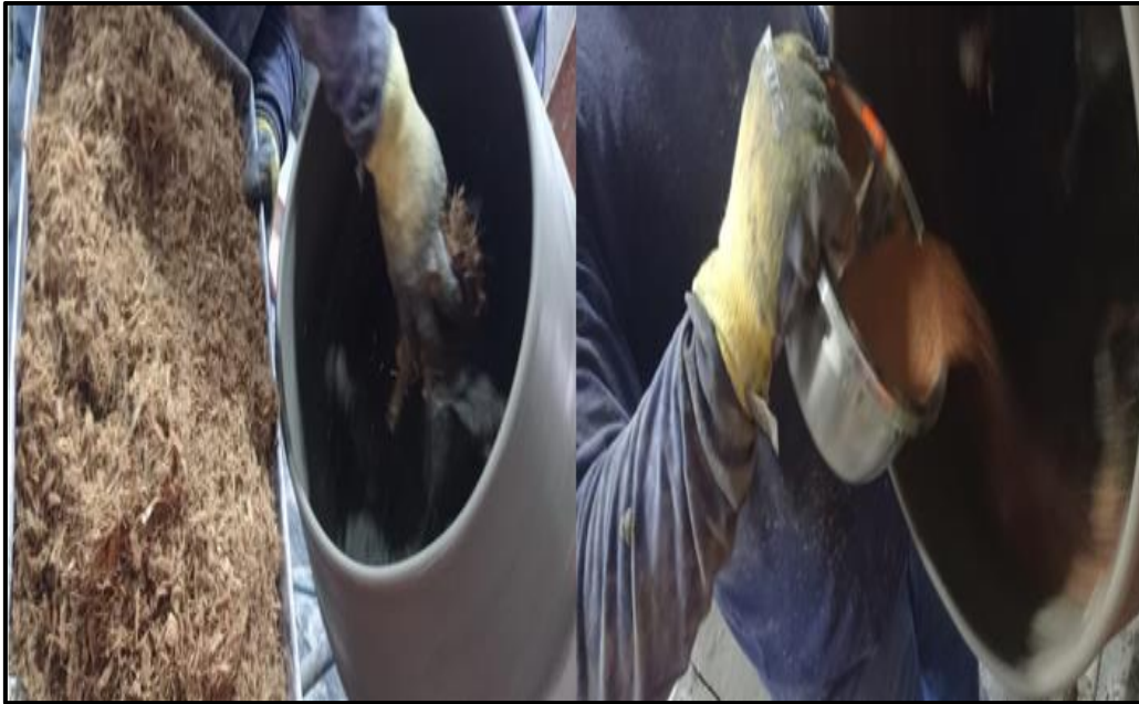
Figura 11. Adición de las fibras y del ladrillo en polvo.
