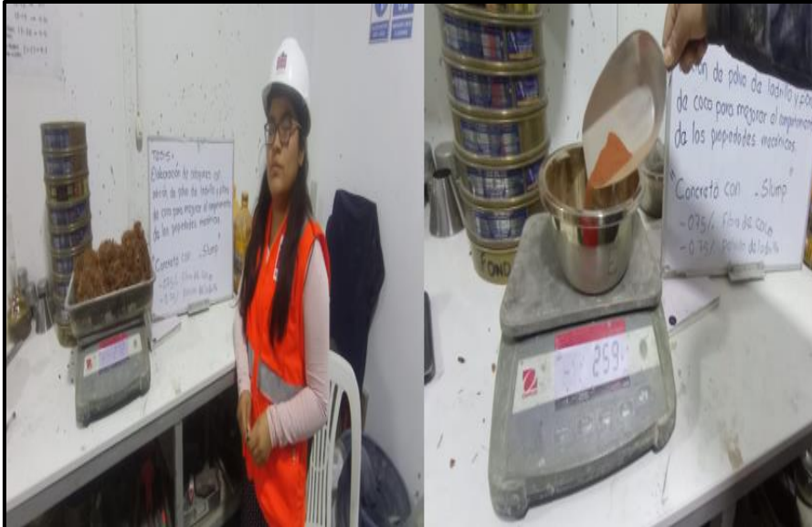
Figura 9. Pesado de la fibra de coco y ladrillo en polvo Fuente: propia
