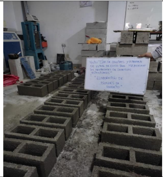
Elaboración de unidades de albañilería
