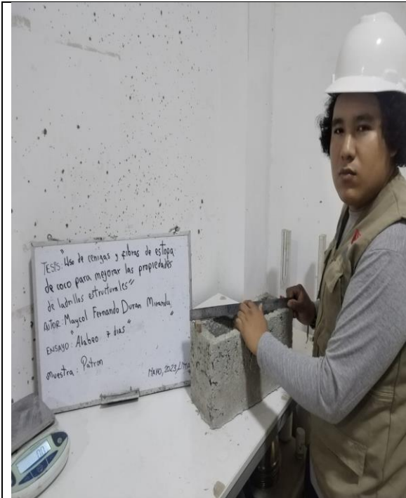
Ensayo de alabeo 7 días
