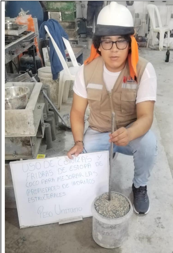
Ensayo de peso unitario del agregado grueso
