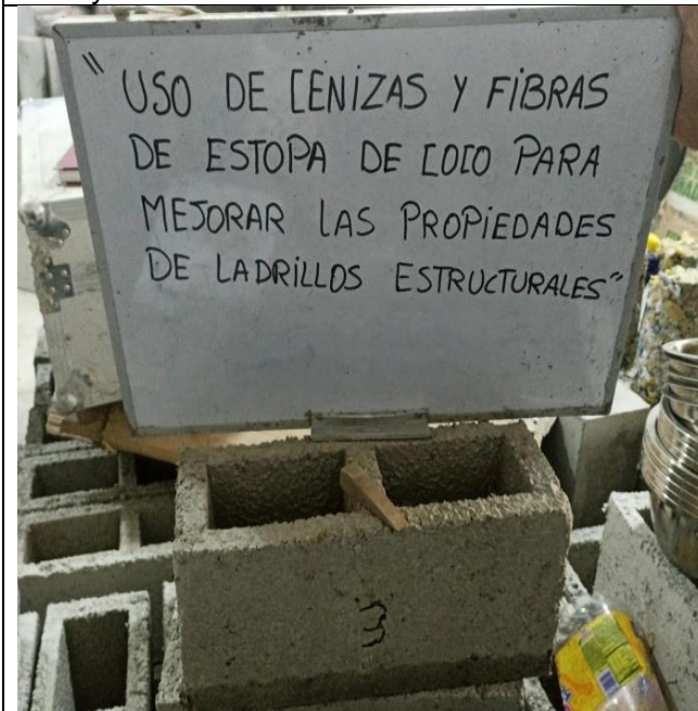
Ensayo de alabeo 14 días
