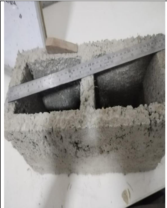
Ensayo de alabeo 7 días
