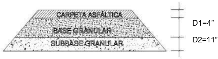
Figura 7: Diseño estructural del pavimento flexible base granular
