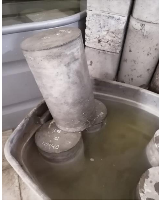
Figura 29: Determinar la impermeabilidad del concreto modificado con Bitumen. Fuente. Elaboración propia.
