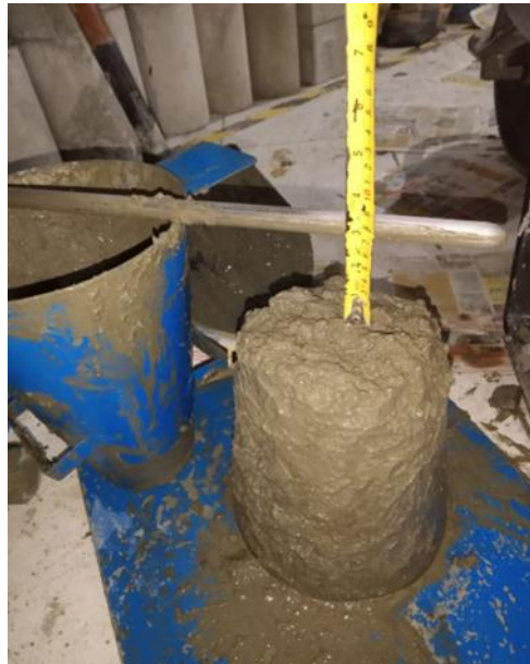
Figura 22. Llenado del concreto en moldes y ensayos de slump al concreto. Fuente. Elaboración propia.
