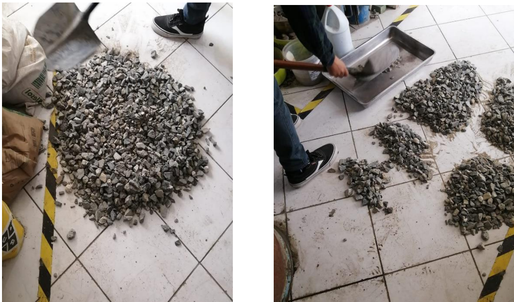
Figura 14: cuarteo y granulometría de la piedra chancada. Fuente: elaboración propia.
