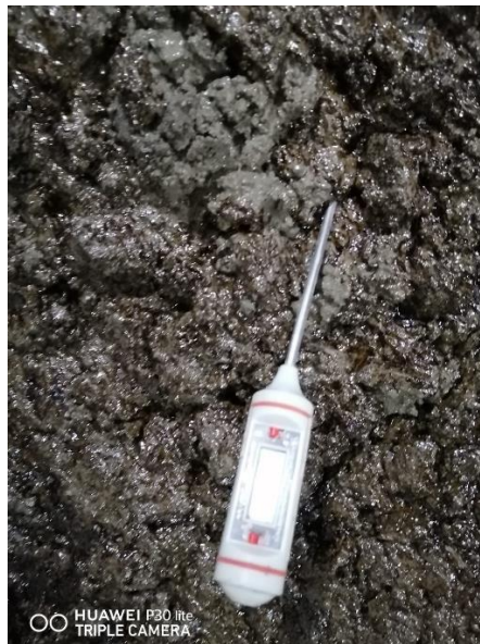
Figura 23. Medición de la temperatura del concreto en mezcla patrón y con adición de bitumen. Fuente. Elaboración propia.
