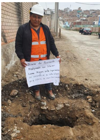
Figura 9. Imagen de la calicata 2 de la zona de estudio – profundidad 1.50 m. Fuente. Elaboración propia.
