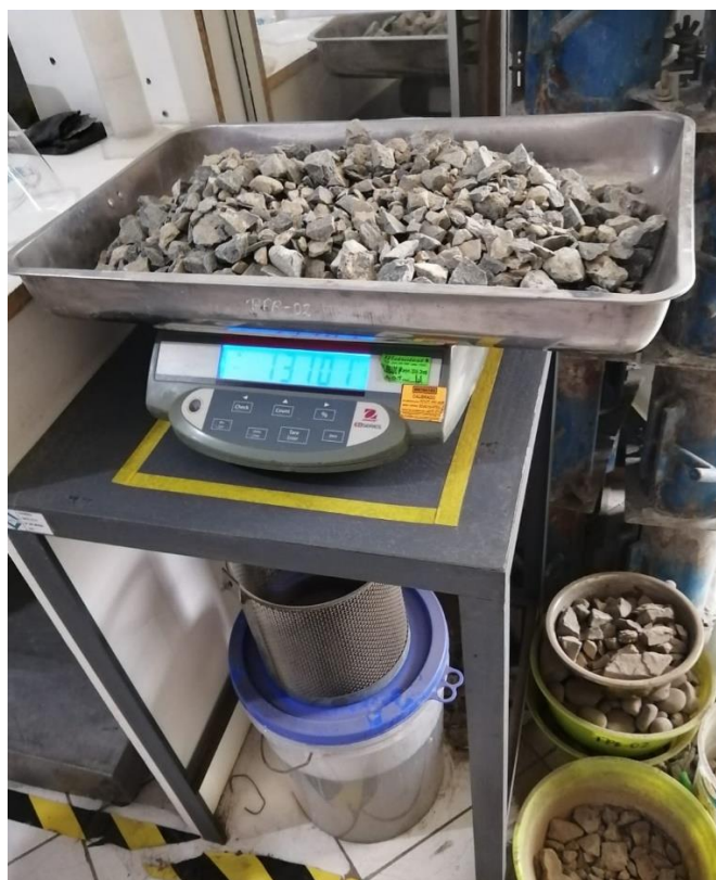
Figura 16: Realizando el ensayo del peso unitario suelto. Fuente: elaboración propia.
