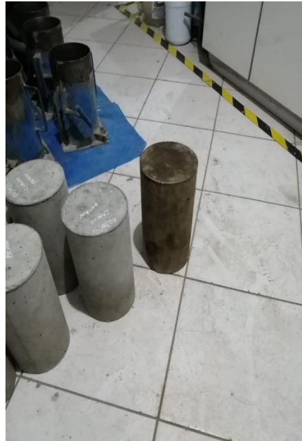
Figura 25: ensayos de rotura a las muestras de concreto. Fuente. Elaboración propia.
