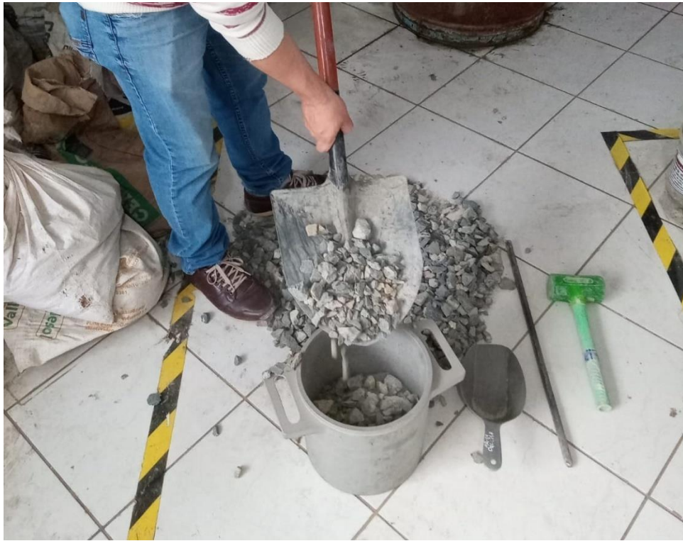
Figura 17: Calculando el peso unitario compactado. Fuente: Elaboración Propia.
