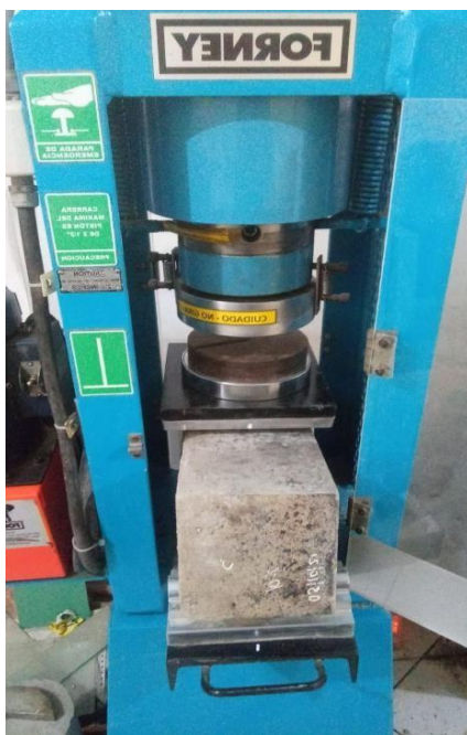
Figura 27: Rotura realizadas a las muestras de las vigas. Fuente. Elaboración propia.
