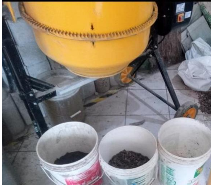
Figura 20: Mezcladora de concreto tipo trompo con motor 13 HP Fuente: Elaboración propia.
