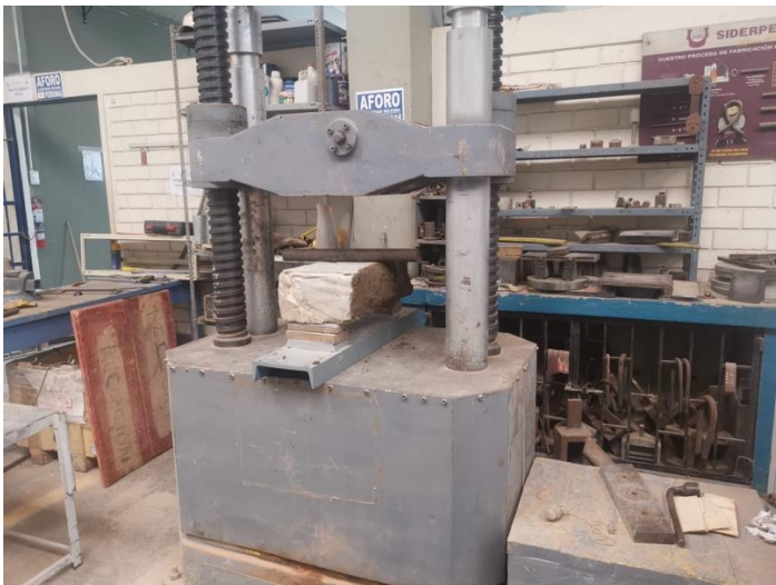
Figura 177. Prueba de resistencia a la compresión
