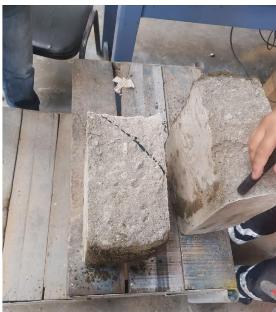
Figura 188. Ensayo de permeabilidad tras 30 días
