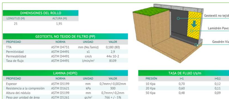
Figura 5. Especificaciones técnicas del geodren lamidren
