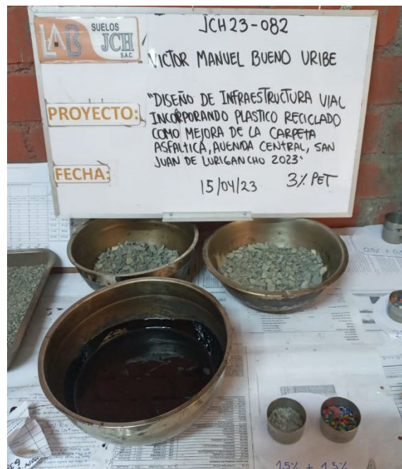
Figura 28. Materiales para elaboración de mezcla asfáltica
