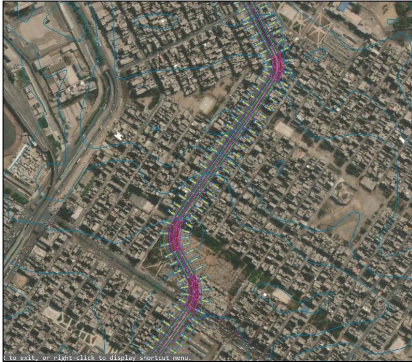
Figura 8. Alineamiento y levantamiento topográfico con Civil 3D – Geolocalización Map Arial
