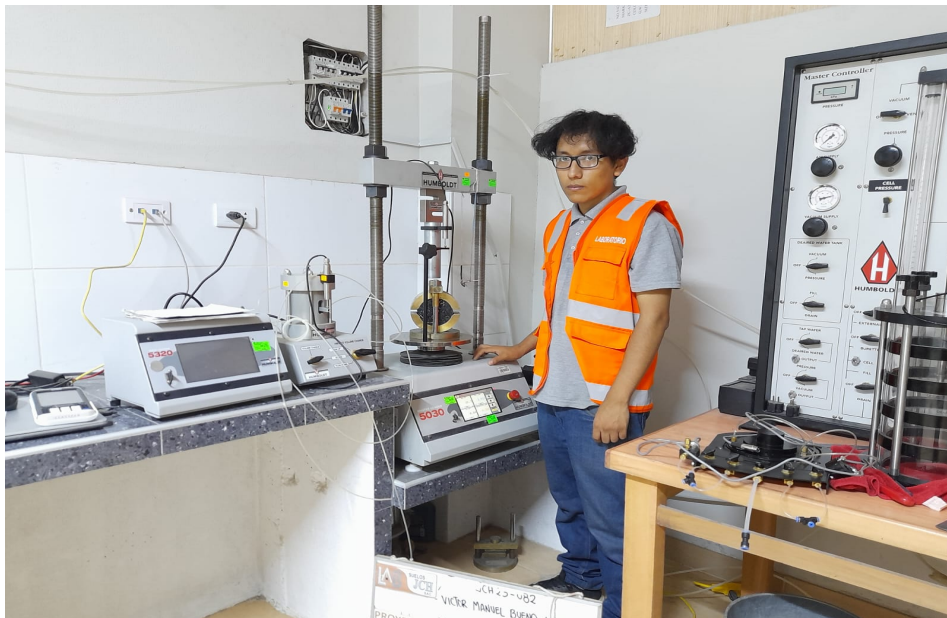
Figura 31. Trabajo de laboratorio, estabilidad Marshall.
