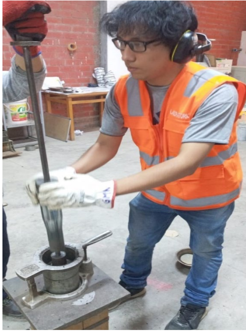
Figura 30. Elaboración de briquetas para las mezclas asfálticas realizados
