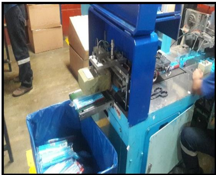
Maquinas sin Guardas de Seguridad
