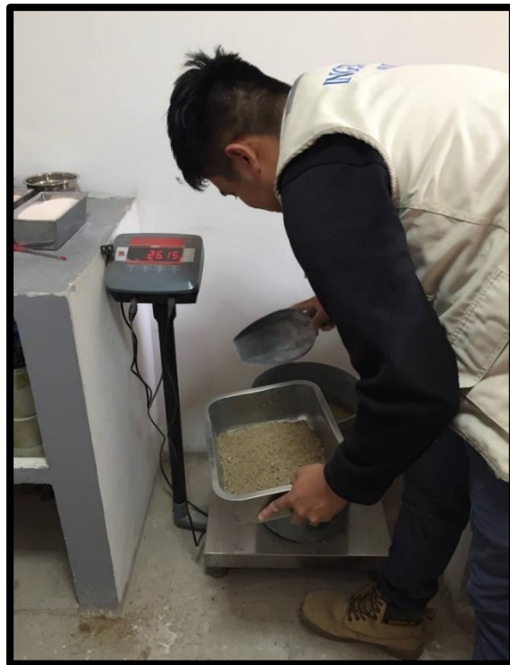
Figura 24. Realizando el peso de la arena para la mezcla de concreto.
