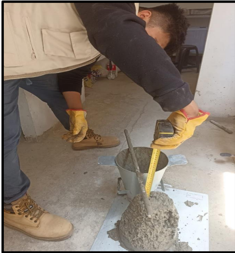
Figura 37. Ensayo de consistencia del concreto.
