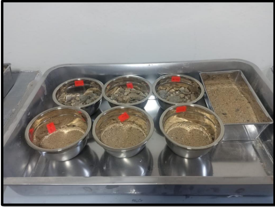
Figura 15. Realización del ensayo de contenido de humedad.
