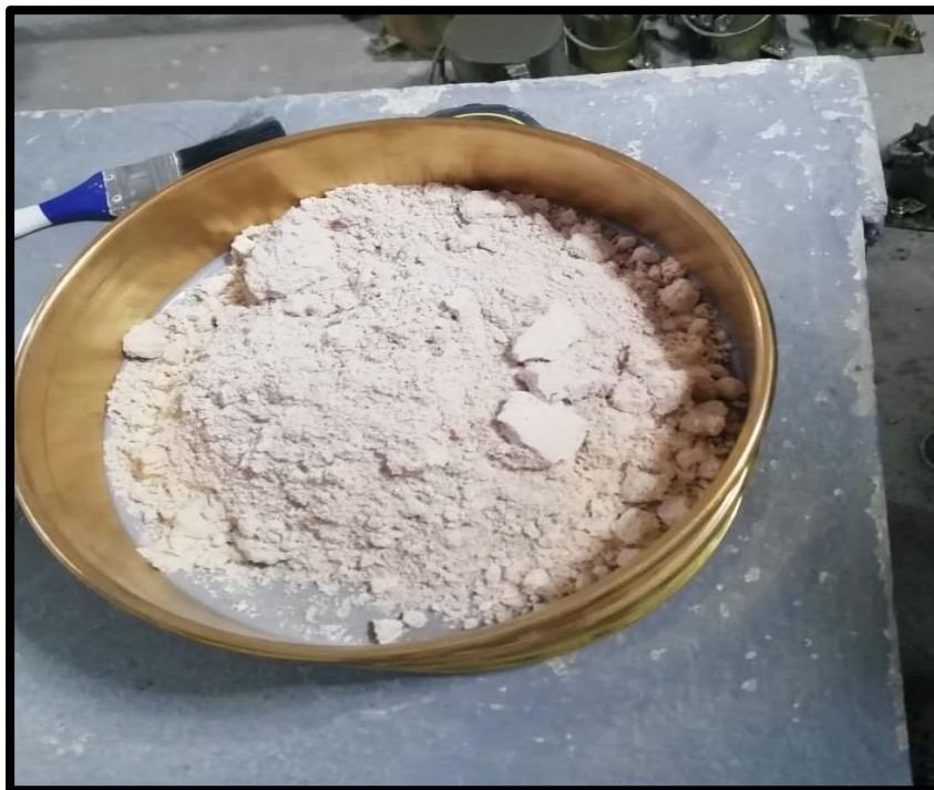
Figura 19. Pulverización de la cascara de huevo.
