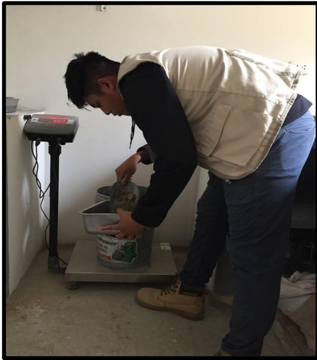
Figura 23. Realizando el peso de la piedra chancada para la mezcla de concreto.
