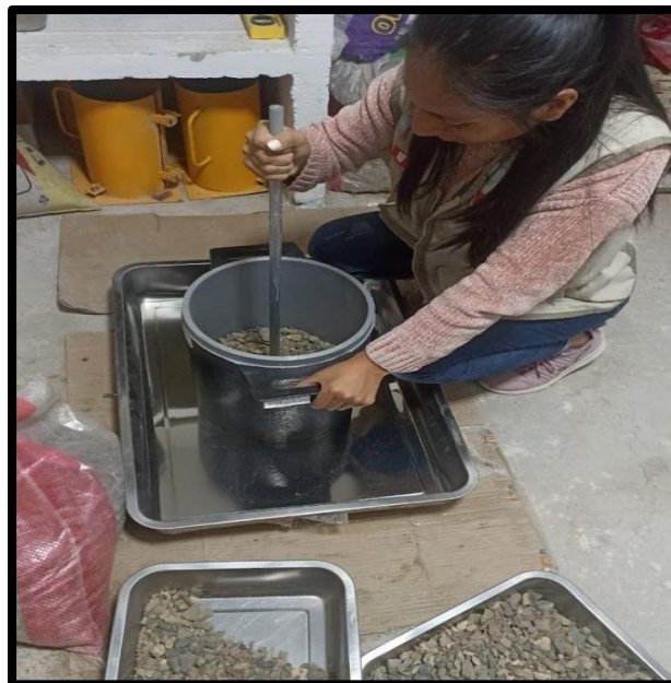
Figura 38. Ensayo de peso unitario y varillado de los agregados
