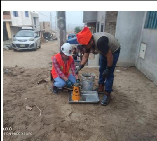
Ensayo de cono de Abrams
