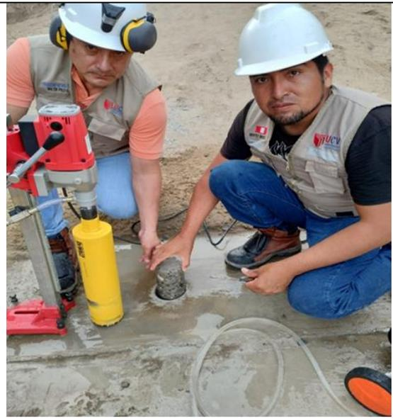
Primer testigo de diamantina concreto patrón
