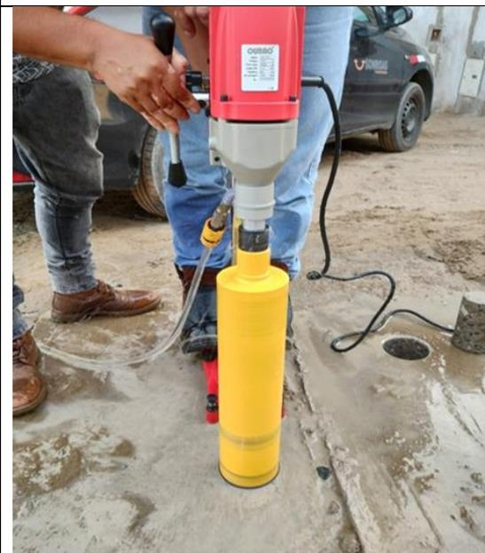
Segundo testigo de diamantina concreto patrón
