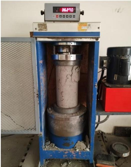
Rotura de probetas 15 cm x 30 cm
