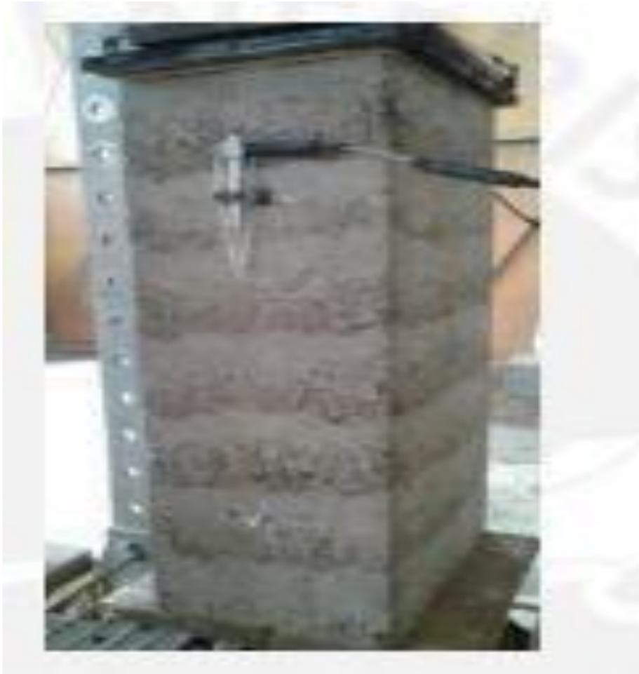
Figura 6. Ensayo en forma de prisma de tapial, Tantalean (2018).
