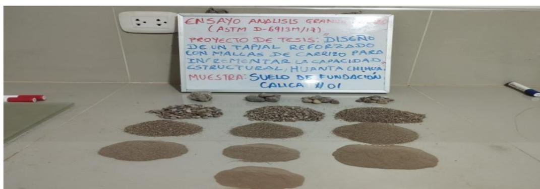
Figura 29. Selección de material según el # de malla del tamiz suelo de fundación
