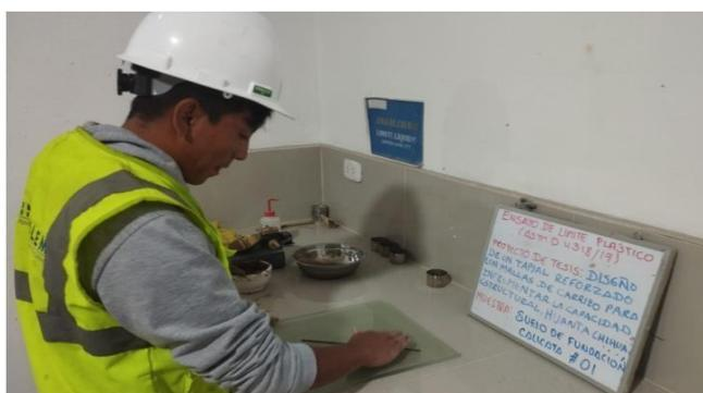
Figura 31. Ensayo de límite plástico
