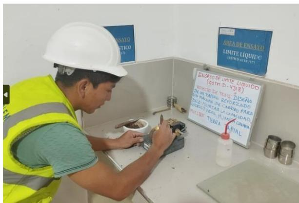
Figura 18. Ensayo de límite líquido
