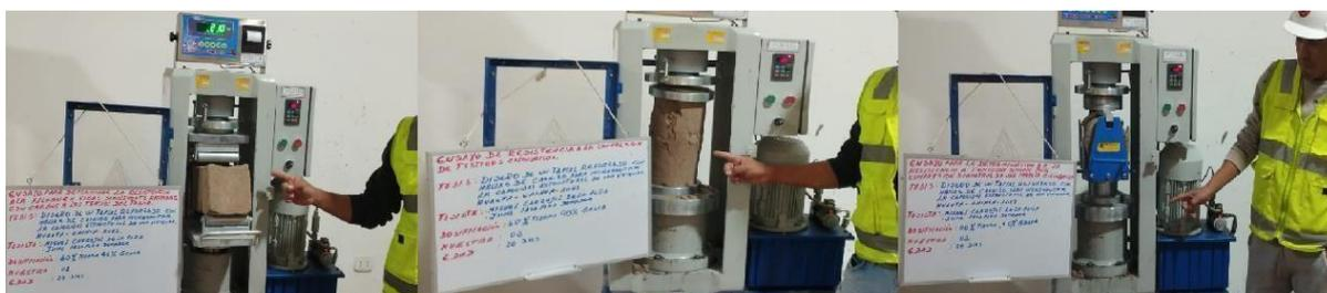
Figura 38. Ensayos flexión, compresión, tracción respectivamente
