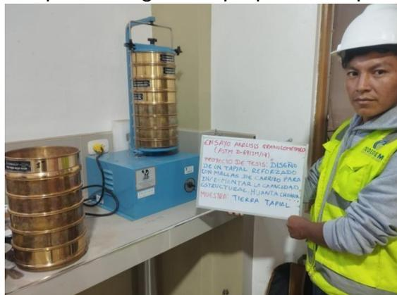
Figura 16. Ensayo granulométrico
