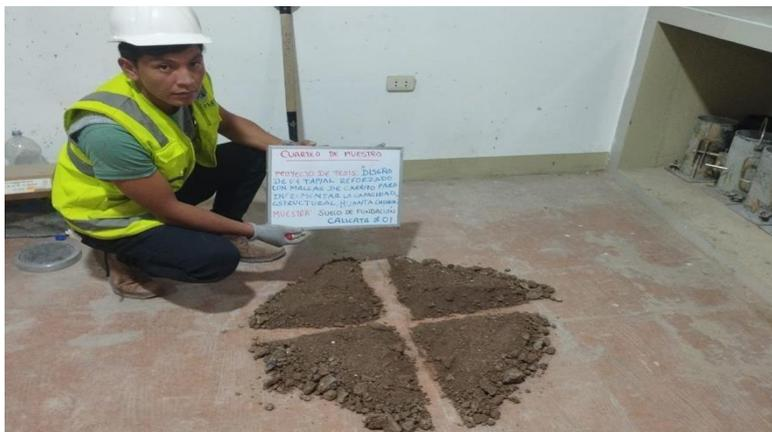
Figura 28. Cuarteo de muestra suelo de fundación
