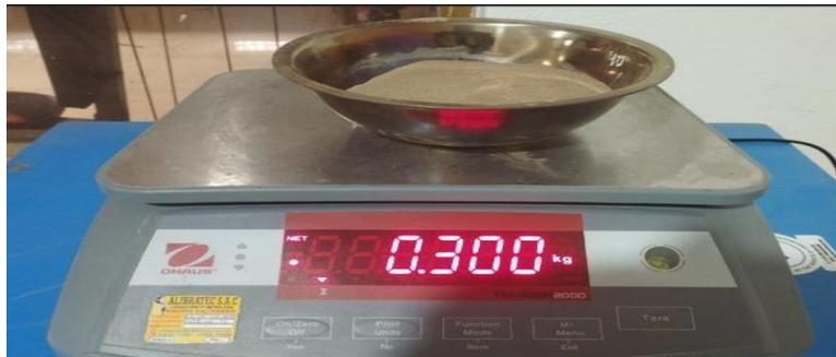
Figura 17. Muestra de material para el ensayo de límites
