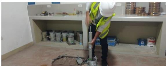
Figura 20. Ensayo de Proctor modificado
