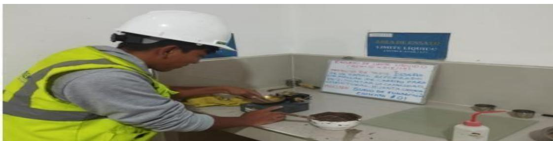
Figura 30. Ensayo de límite líquido Copa de Casagrande suelo de fundación
