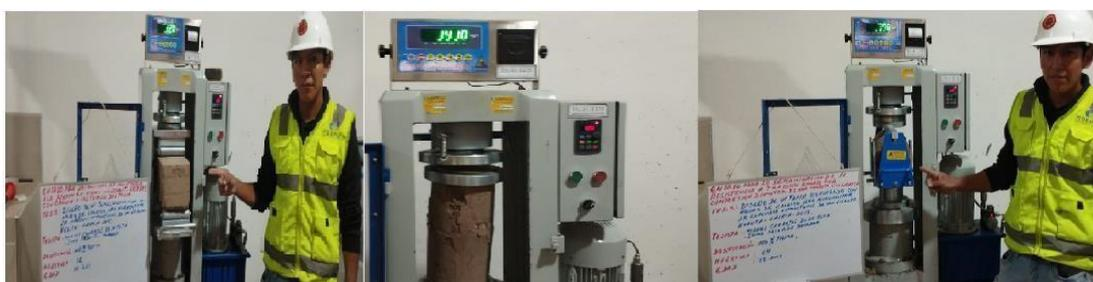
Figura 36. Ensayos flexión, compresión, tracción respectivamente
