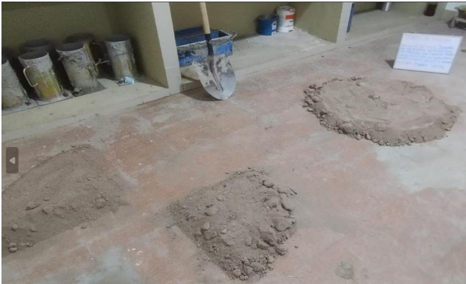
*Imagen propia N°5: Extracción diagonal para ensayo granulométrico*
