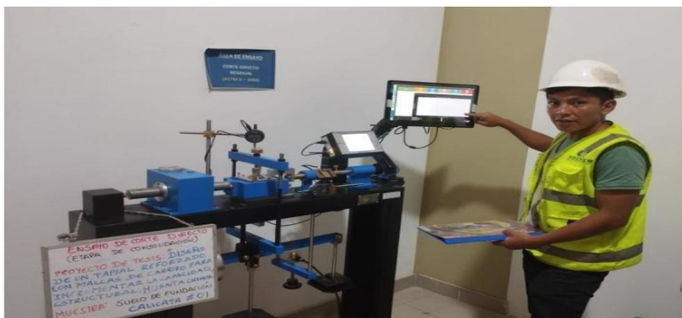
Figura 32. Lectura del ensayo de corte directo etapa de consolidación
