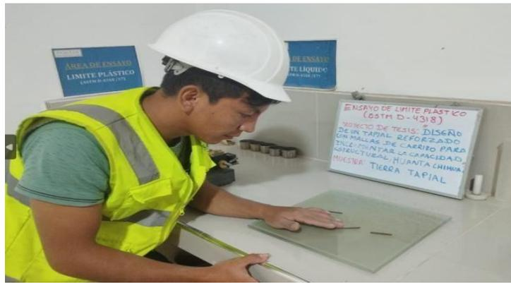
Figura 19. Ensayo de límite plástico
