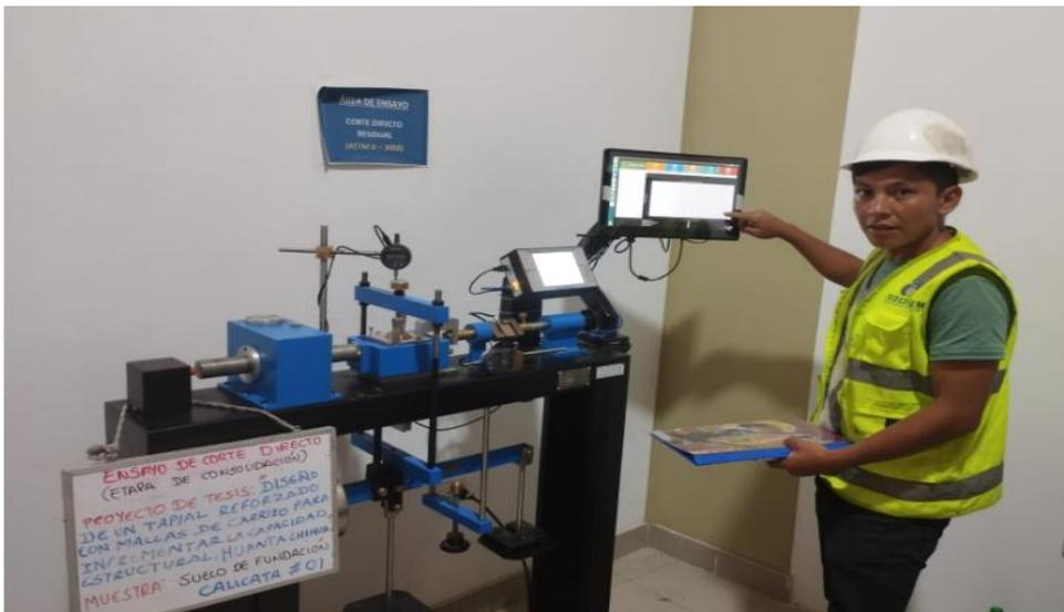
Imagen propia N°38: lectura del ensayo de corte directo, suelo de fundación
