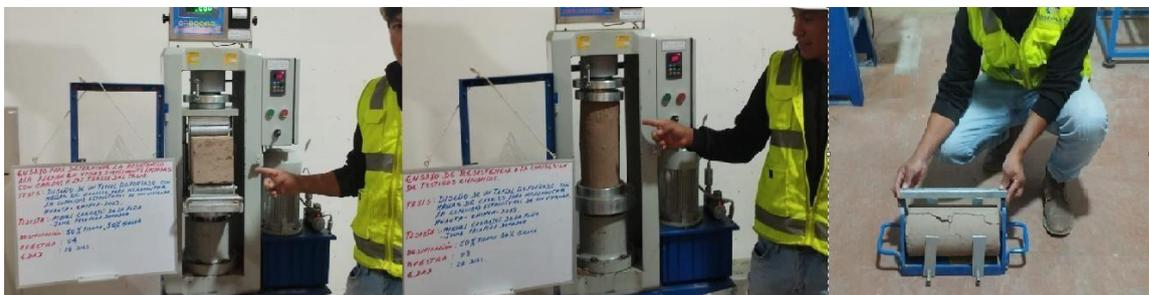
Figura 39. Ensayos a flexión, compresión y tracción respectivamente
