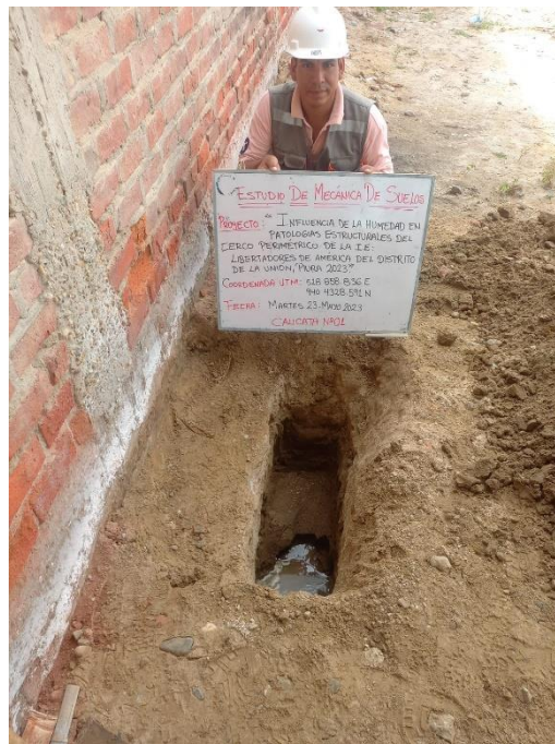
Figura 2. Nivel freático en el suelo (Elaboración Propia, 2023)
