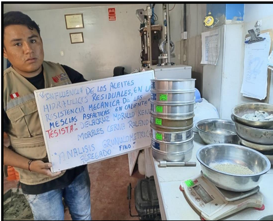
Figura 8. TAMIZADO AGREGADO FINO
