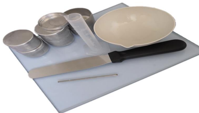
Figura 7. Taras, cápsula, espátula y placa de vidrio esmerilado. Fuente: Imagen referencial, elaboración propia
