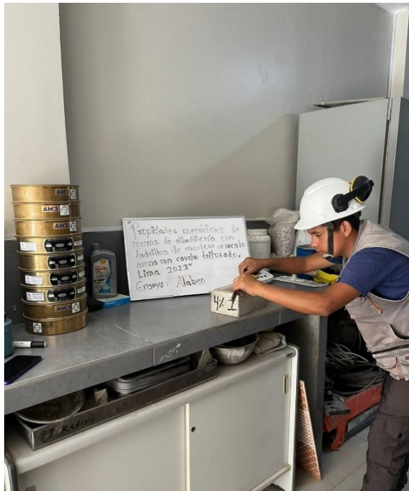
6) Ensayo de alabeo en unidades de ladrillo
