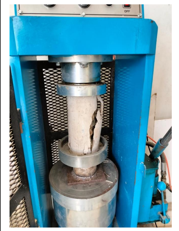
Rotura de probetas de concreto en porcentajes de 3%, 6% y 9%
