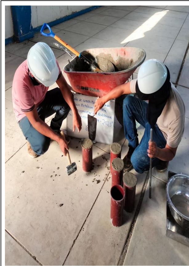
Elaboración de probetas de concreto (NTP 339.033)
