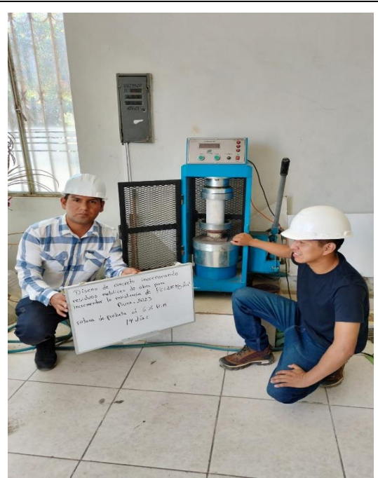
Rotura de probetas de concreto en porcentajes de 3%, 6% y 9%
