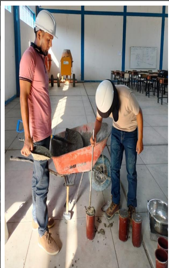
Elaboración de probetas de concreto (NTP 339.033)
