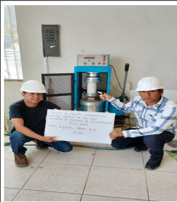
Rotura de probetas de concreto en porcentajes de 3%, 6% y 9%
