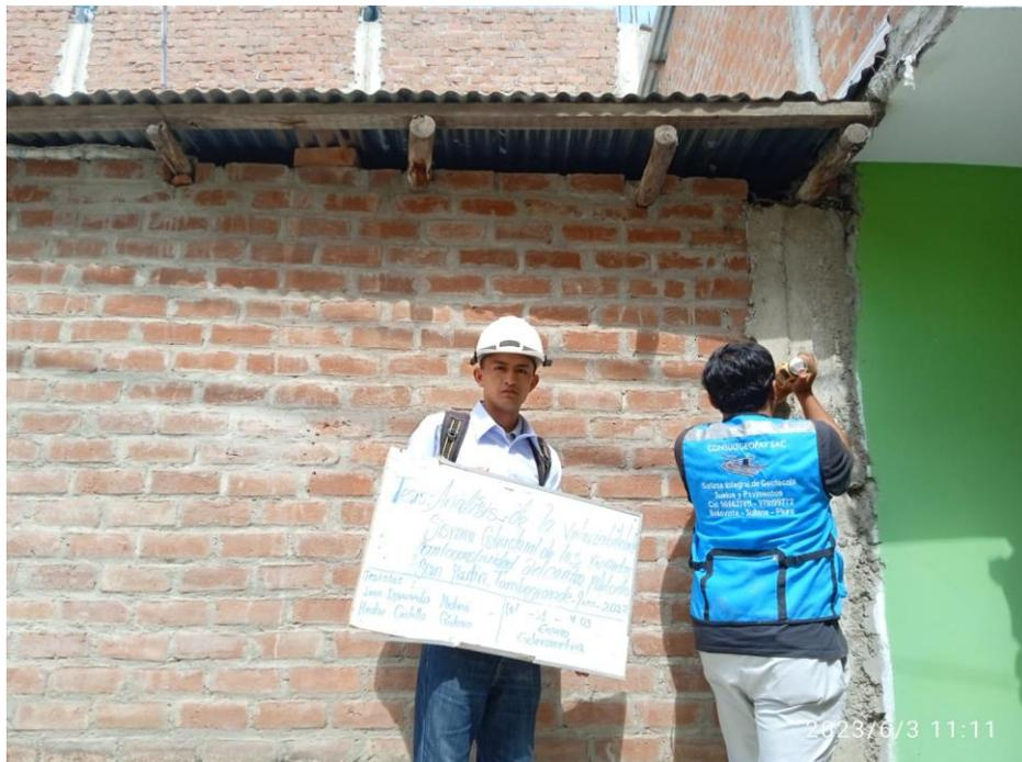
**Figura 10:** Aplicación del ensayo de esclerometría realizado en la Vivienda 02, Col-01 del C.P. San Martin-Tambogrande
