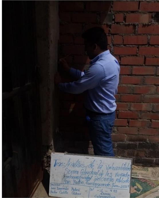
**Figura 09:** Toma de datos y realización del área para la aplicación del ensayo de esclerometría en la vivienda 03, Col-02 C.P. San Martin-Tambogrande.
