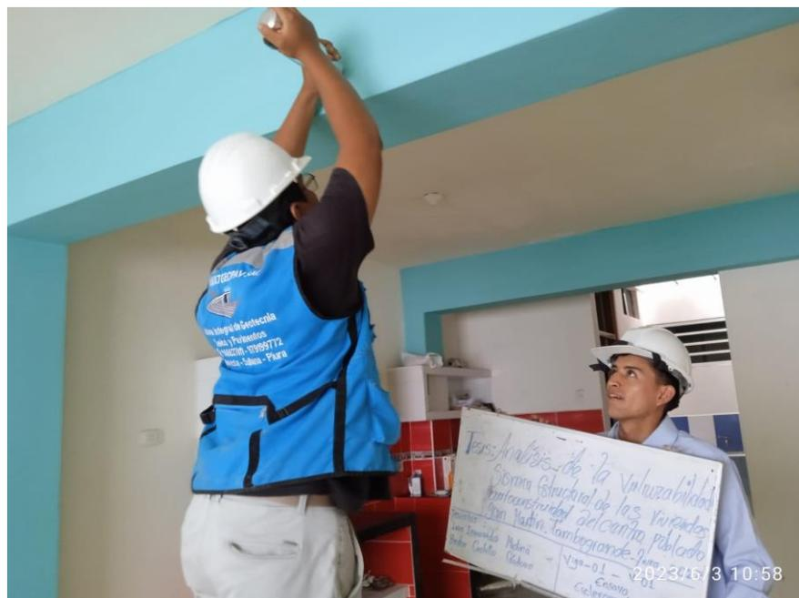
**Figura 12:** Aplicación del ensayo de esclerometría realizado en la Vivienda 03, Viga-01 del C.P. San Martín-Tambogrande
