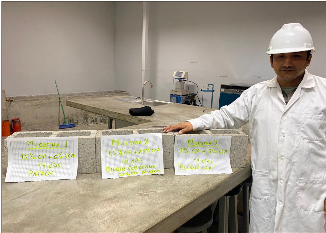
Fotografía 7. Bloques de concreto a 14 días de curado
