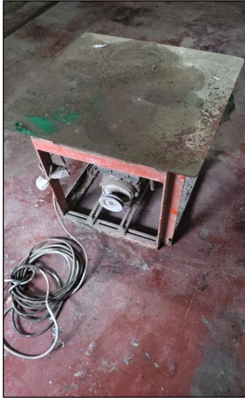
Fotografía 4. Mesa Vibratoria para el compactado uniforme del bloque.
