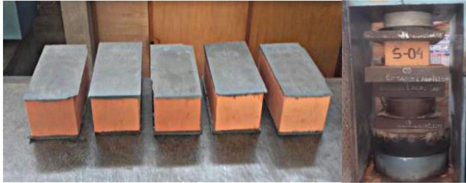
Fig 12. capping colocado de ladrillos y Ensayo a compresión. Tomado de (Ornella et al., 2017).
